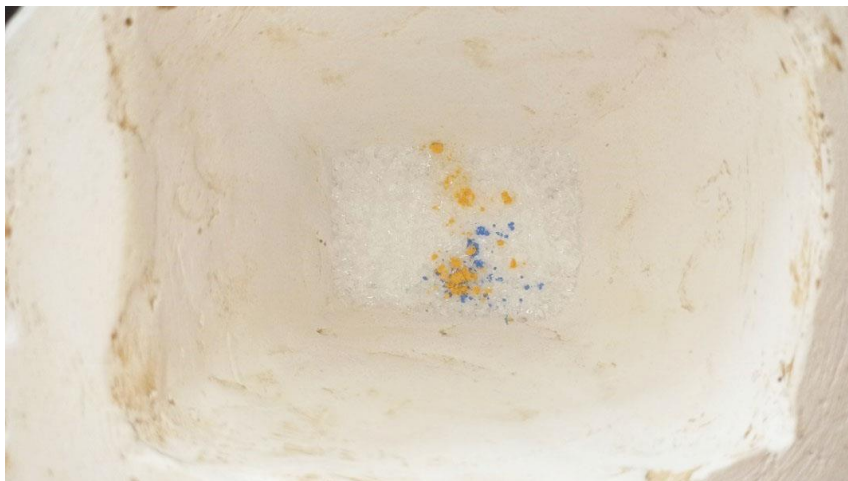
Obrázek 7: Přidávání barev a frity postupně [20]
