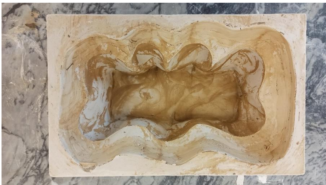
Obrázek 18: Čištění formy od hlíny [20]
