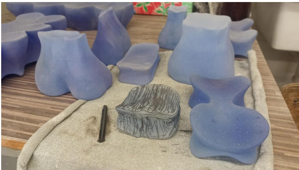
Obrázek 27: Příprava skleněných objektů na pískování [20]
