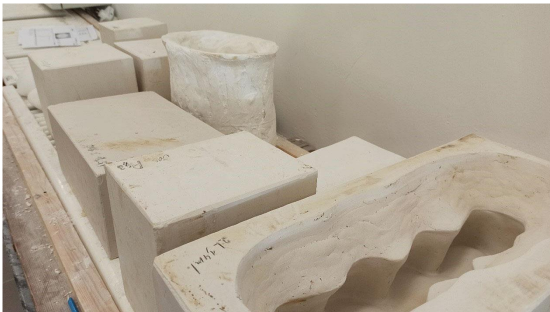
Obrázek 19: Sušení forem na radiátoru [20]
