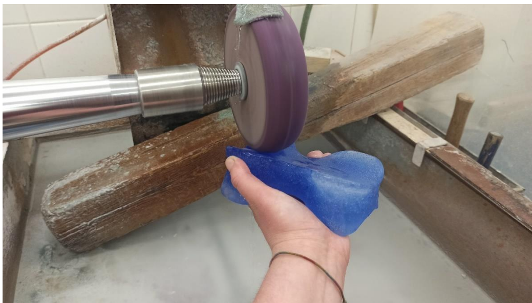
Obrázek 25: Broušení skleněných objektů [20]
