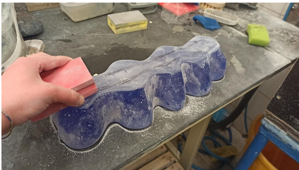
Obrázek 26: Začištění hran skleněných objektů [20]
