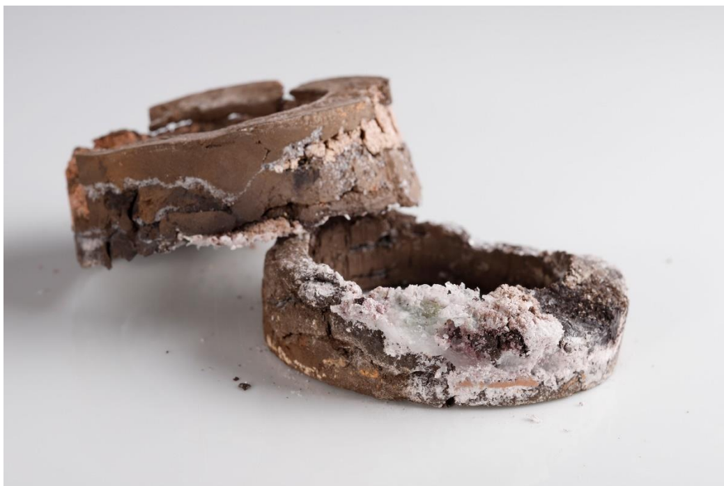
Obrázek 35: Zkouška výpalu hlíny s fritou a dalšími příměsi [20]
