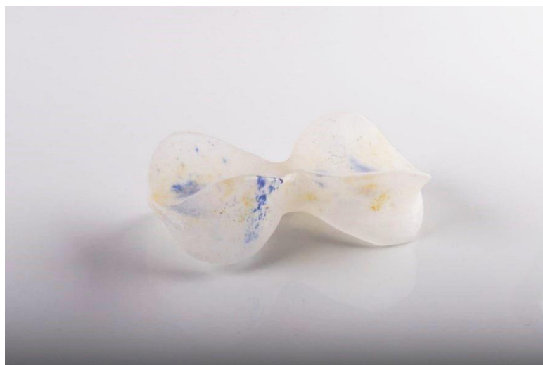
Obrázek 11: Výsledek zkoušky tavby tvaru fytolitu se sklářskou barvou [20]
