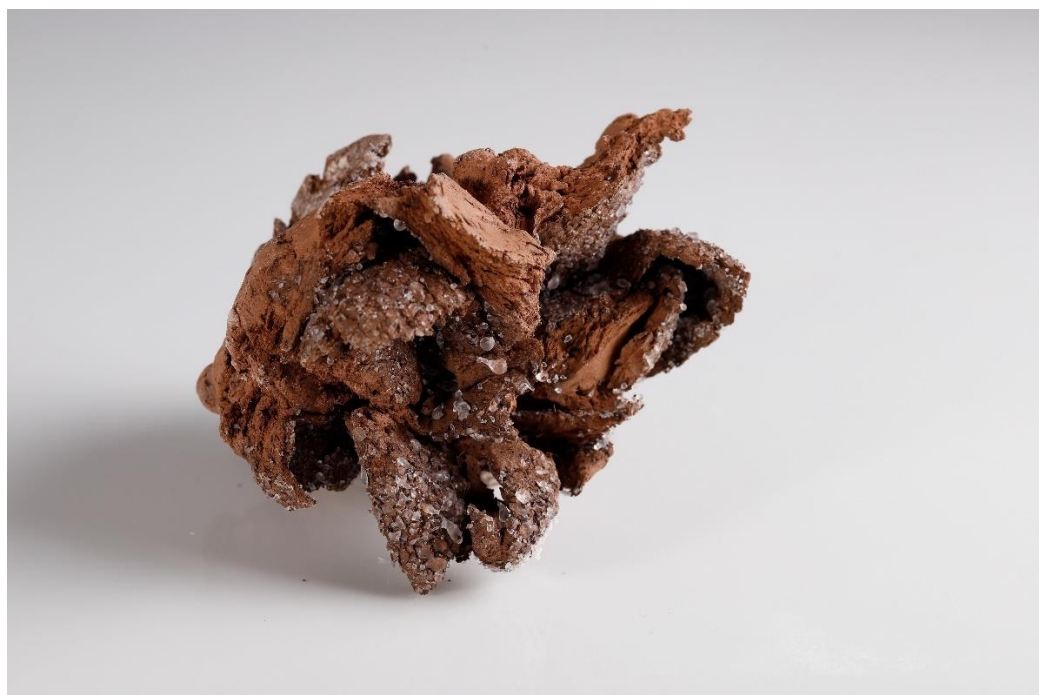
Obrázek 36: Zkouška výpalu hlíny s fritou [20]
