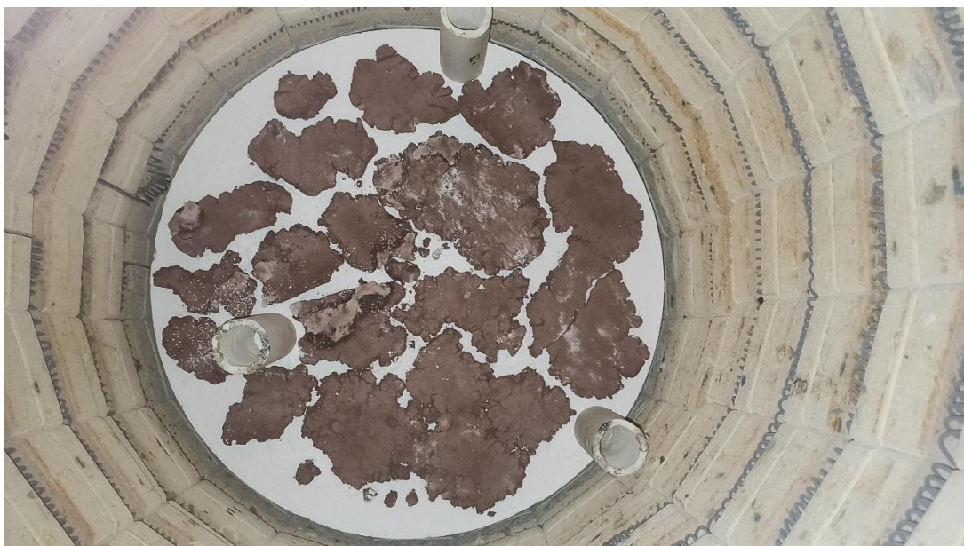
Obrázek 40: Příprava výpalu nového materiálu v keramické peci [20]
