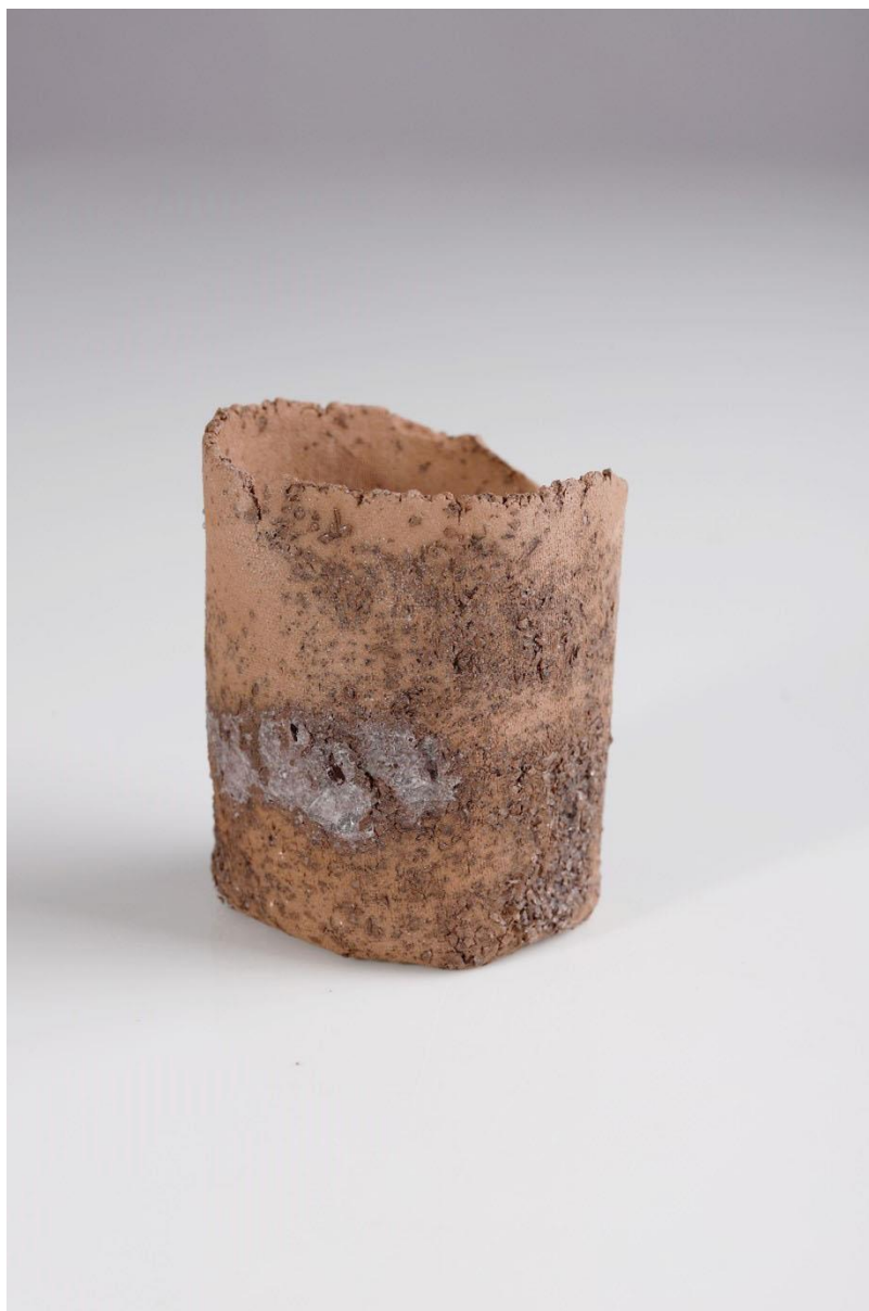
Obrázek 33: Zkouška výpalu hlíny s fritou [20]
