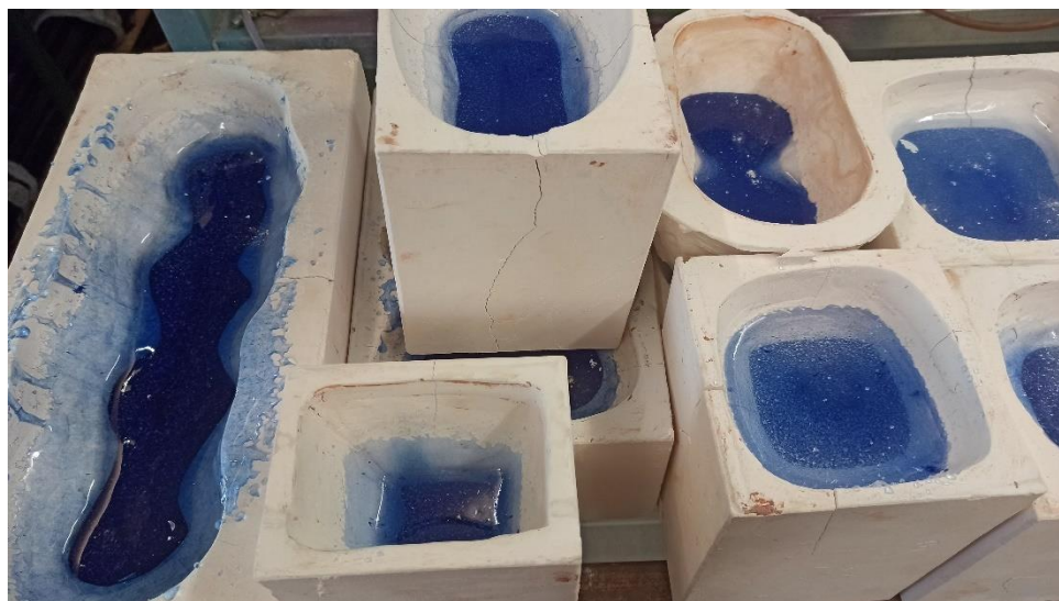
Obrázek 23: Formy se sklem vyndané z pece [20]
