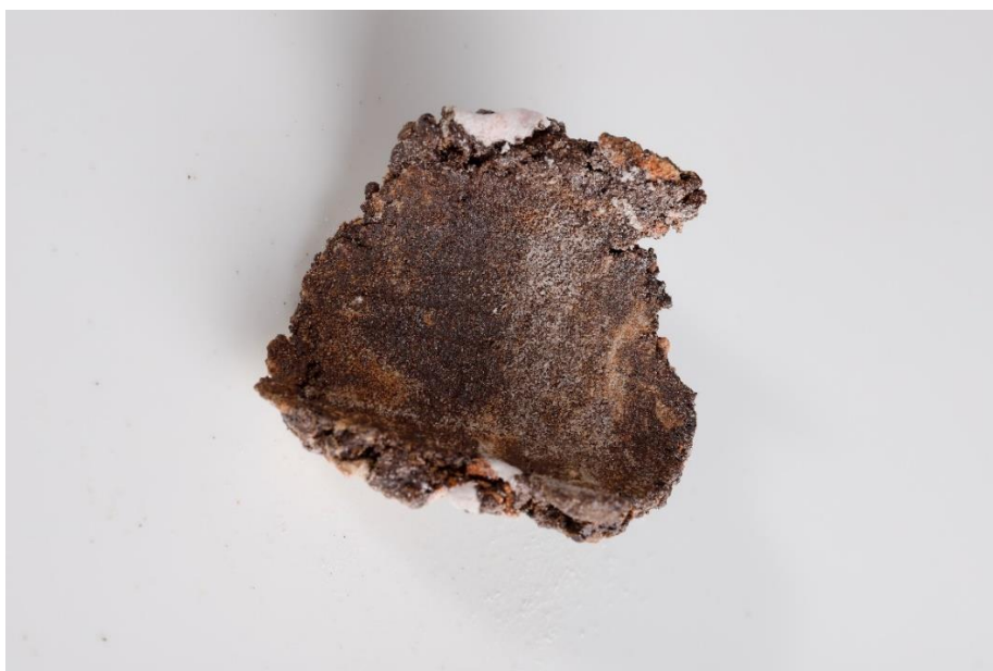
Obrázek 38: Zkouška výpalu hlíny se sklo-keramickým materiálem [20]
