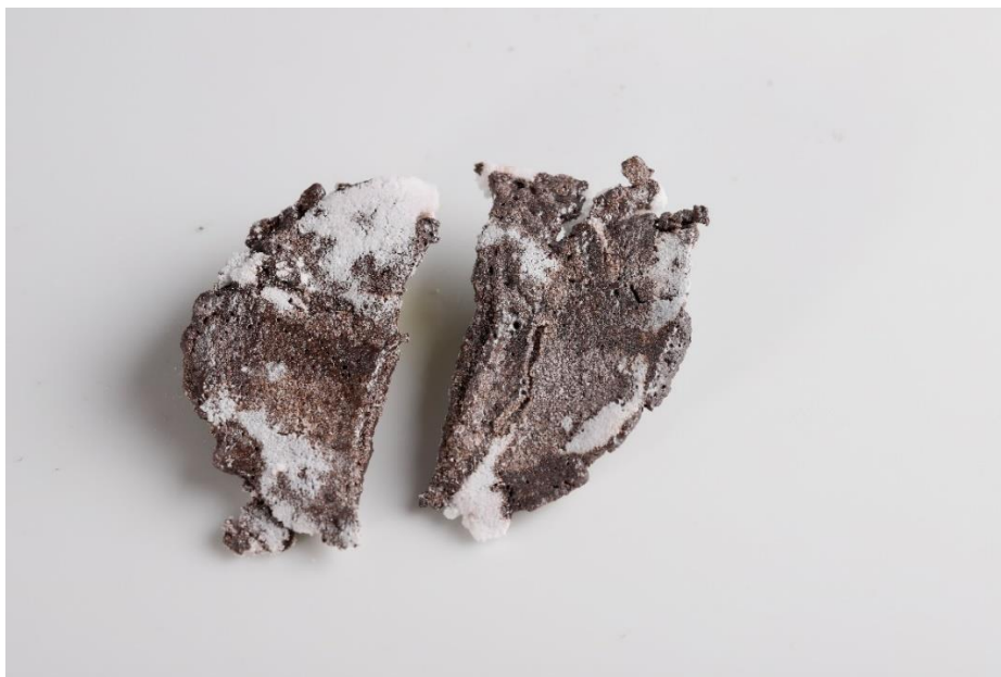
Obrázek 37: Zkouška výpalu hlíny se sklo-keramickým materiálem [20]
