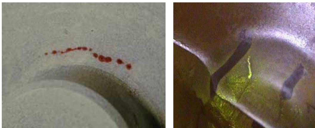
Obrázek č. 1: Zjištěná indikace pomocí a) červeného penetrantu, b) UV-světla
