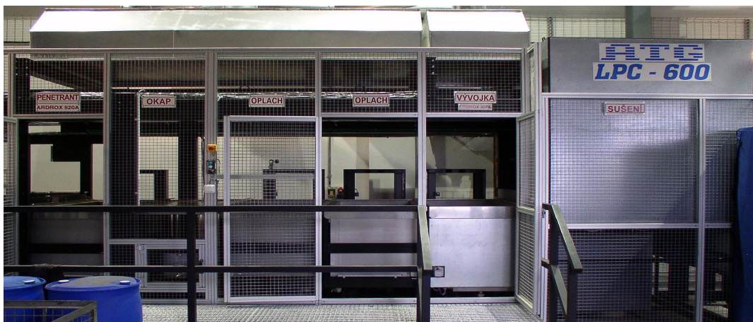
Obrázek č. 4: Kapilární linka - vany
