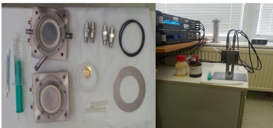
Obr. 4.3 Příprava vzorků na novém pracovišti a plnění elektroodového systému Agilent 16452A
