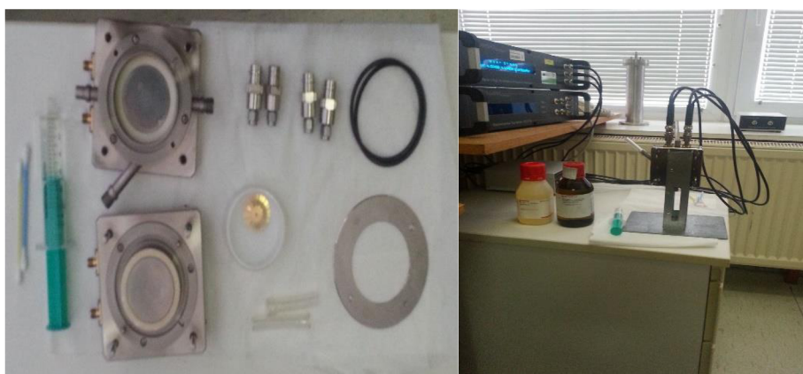
Obr. 4.3 Příprava vzorků na novém pracovišti a plnění elektrodotového systému Agilent 16452A
