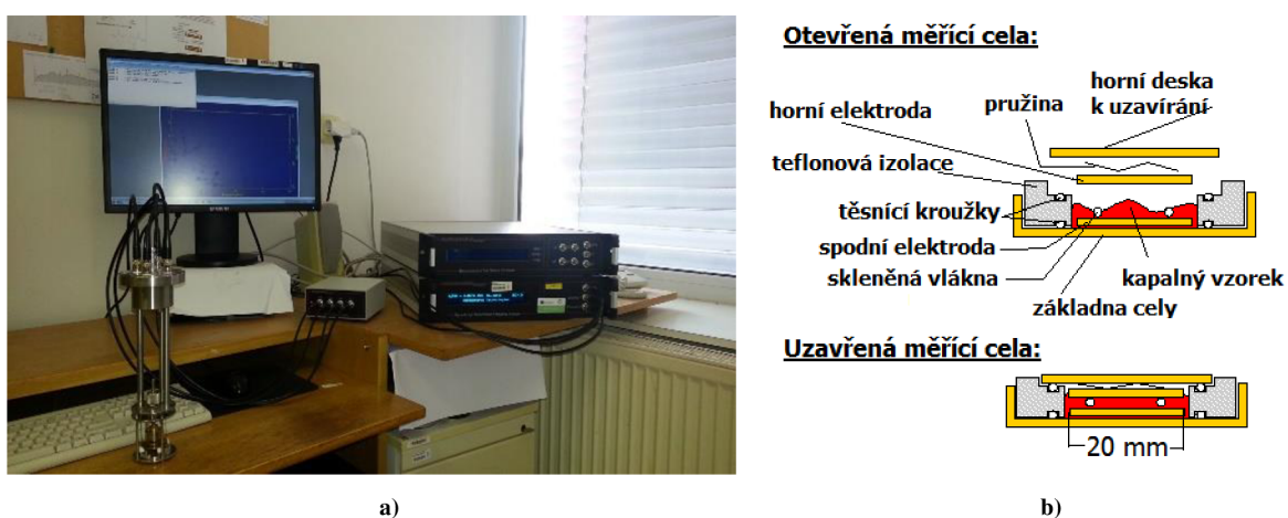
Obr. 4.16 a) Experimentální pracoviště s elektrodovým systémem pro měření pevných vzorků při pokojové teplotě, b) měřicí cely pro kapalné materiály BDS 1308 [55]
