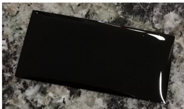
Obrázek 39: Rovnoměrné rozlití pojiva
