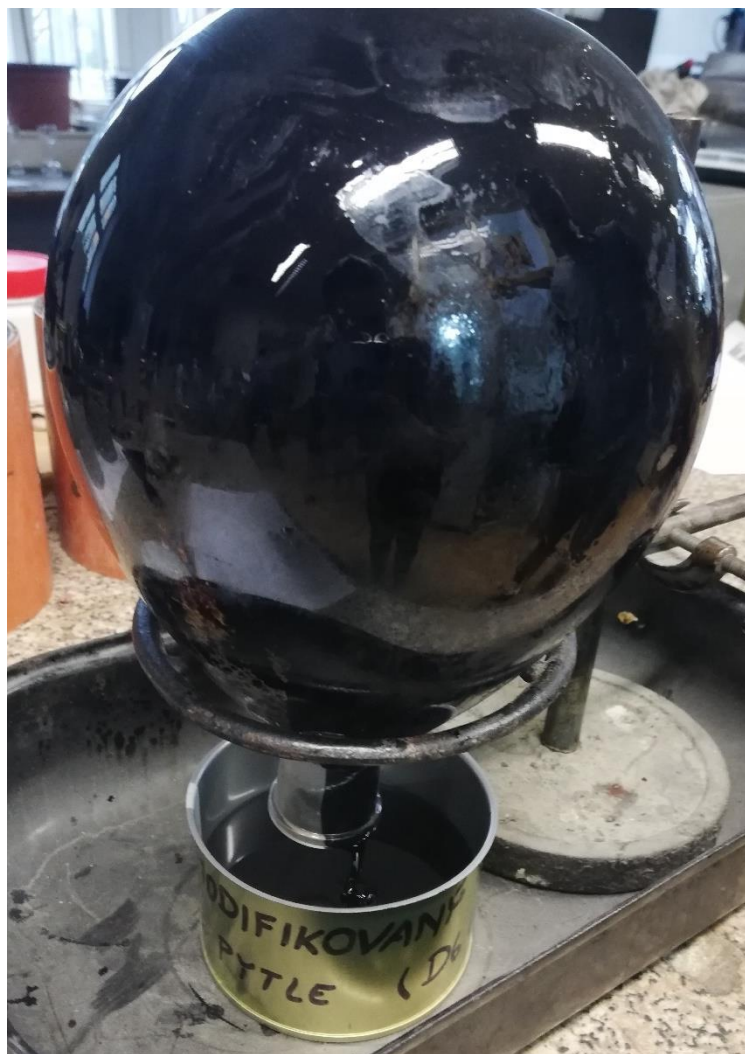
Obrázek 29: Přelití pojiva do vhodné nádoby
