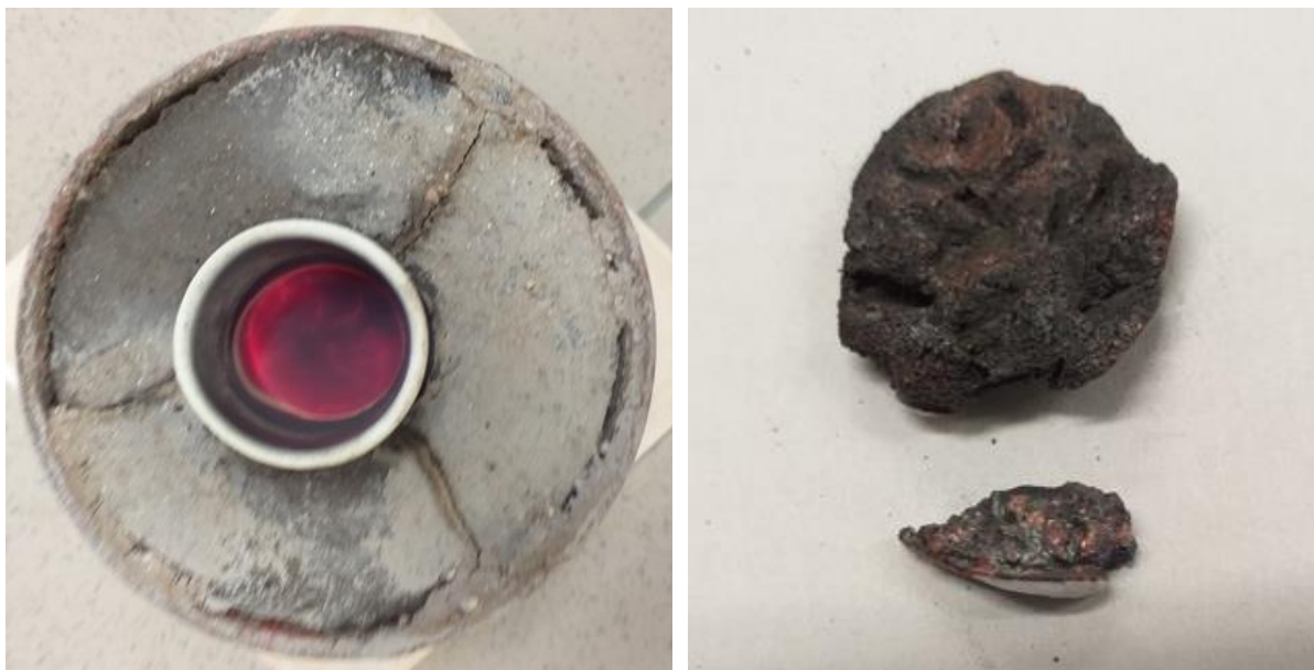
Obrázek 44: Výroba mosazi v mikrovlnné troubě Foto autorka
