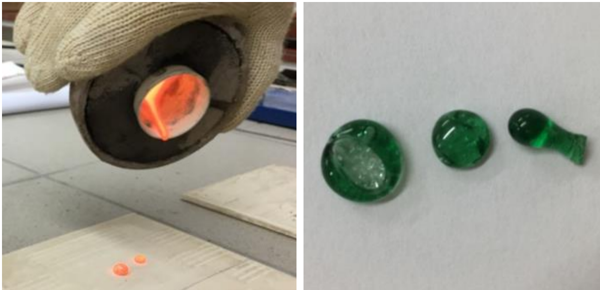
Obrázek 43: Výroba skla v mikrovlnné troubě Foto autorka
