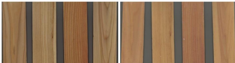
Obrázek 20 Skupina vzorků E ( \text{TiO}_2+\text{ZrNH123} ) před a po expozici
