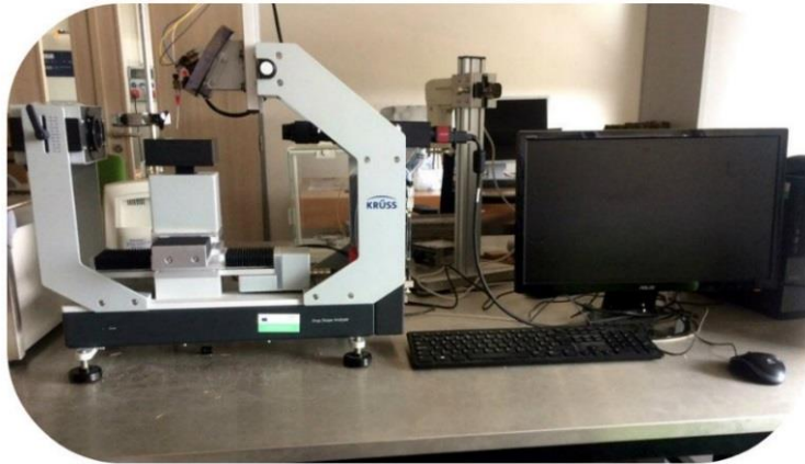
Obrázek 12 Použitý goniometr Krüss DSA 30E (Krüss, Německo)
