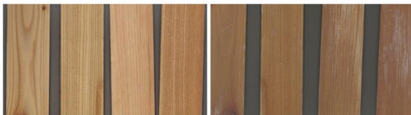
Obrázek 21 Skupina vzorků F ( \text{TiO}_2\text{NH123} ) před a po expozici
