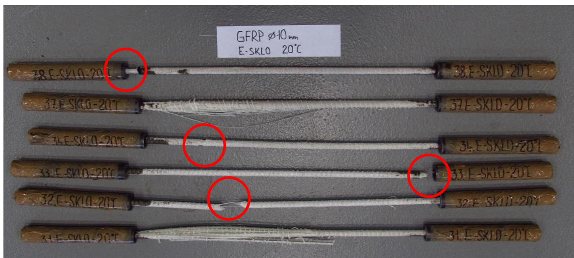
Obrázek 17: Porušení výztuží na daných vzorcích FRP výztuže s vlákny E-SKLA při teplotě uložení 20 °C
