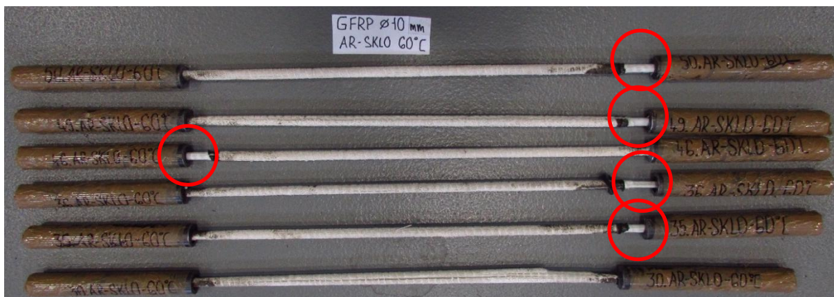
Obrázek 21: Porušení výztuží na daných vzorcích FRP výztuže s vlákny AR-SKLA při teplotě uložení 60 °C
