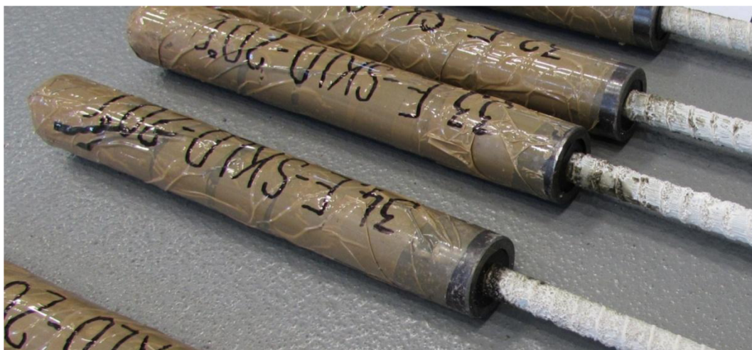
Obrázek 10: GFRP výztuž centricky zalitá epoxidovou pryskyřicí do ocelové koncovky
