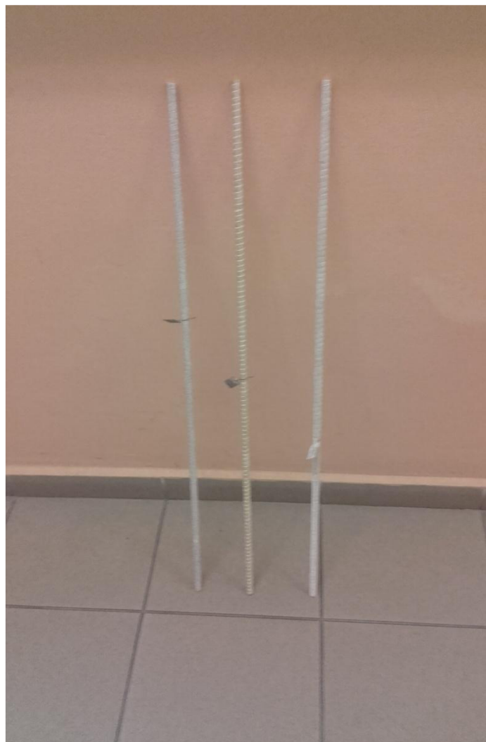
Obrázek 9: Porovnání vzorků uložených v degradačním prostředí při teplotách 20 °C (vlevo), 40 °C (uprostřed) a 60 °C (vpravo).
