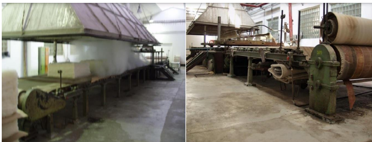
Obrázek 5: Průmyslový plstící stroj [26]
