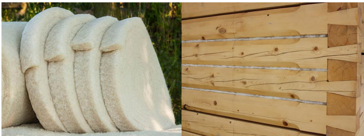
Obrázek 2: Izolační pásy z ovčí vlny [14]
