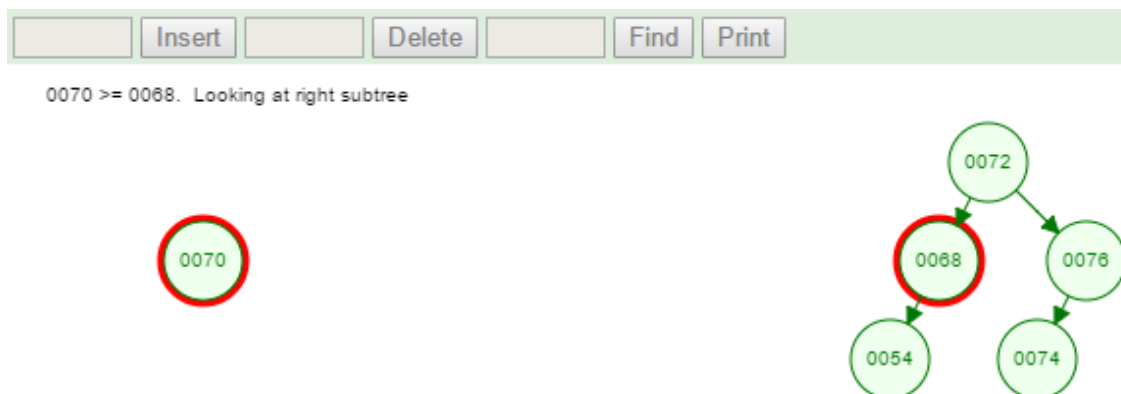
Obrázek 2.6: Zobrazení dynamické struktury typu binární vyhledávací strom s právě vkládaným prvkem v [1]
