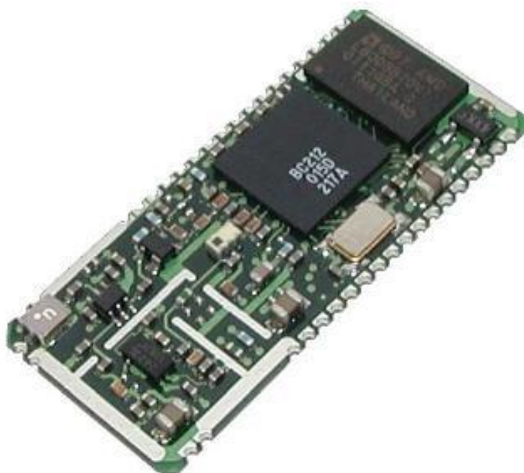
Obr. 5.6: Deska plošného spoje BlueTooth modulu (převzato z [3])
