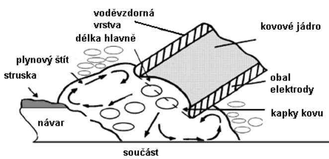
Obr. 3 - schéma svařovacího procesu
