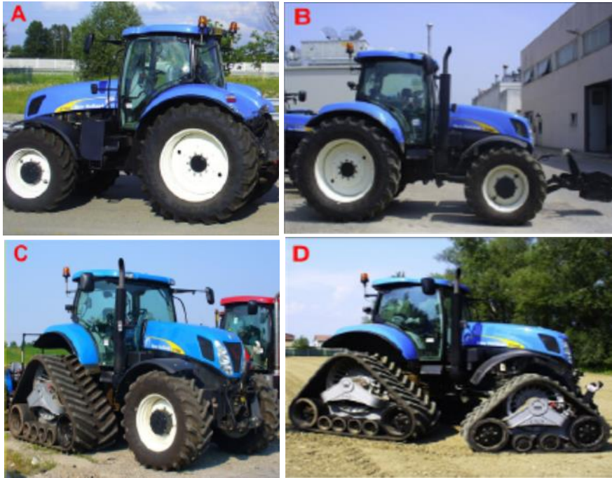
Obrázek 26. Podvozkové verze použité na standartním zemědělském traktoru A – kolový podvozek (tlak v pneumatikách 16 kPa) B – kolový podvozek (pneumatiky vyplněny vodou) C – polopásový podvozek, D – plně pásový podvozek.
