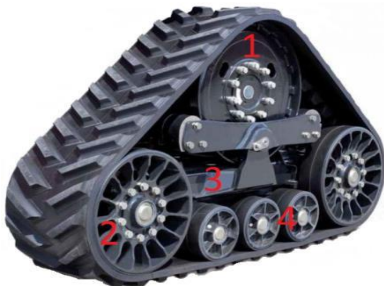
Obrázek 4. 1 – Hnací kolo, 2 – Napínací kolo, 3 – Nosný rám, 4 – vodící kladky
