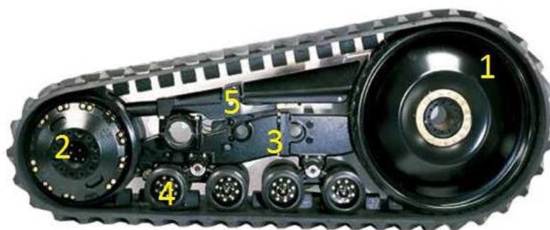
Obrázek 2. 1 – hnací kolo, 2 – napínací kolo, 3 – nosný rám, 4 – vodící kladky, 5 – napínací mechanismus
