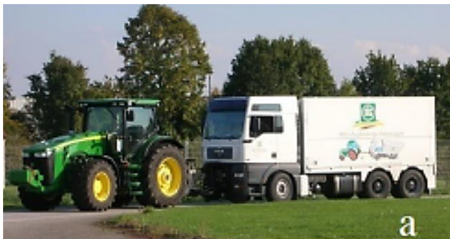
Obrázek 10. Měřicí vozidlo pro měření tahových vlastností
