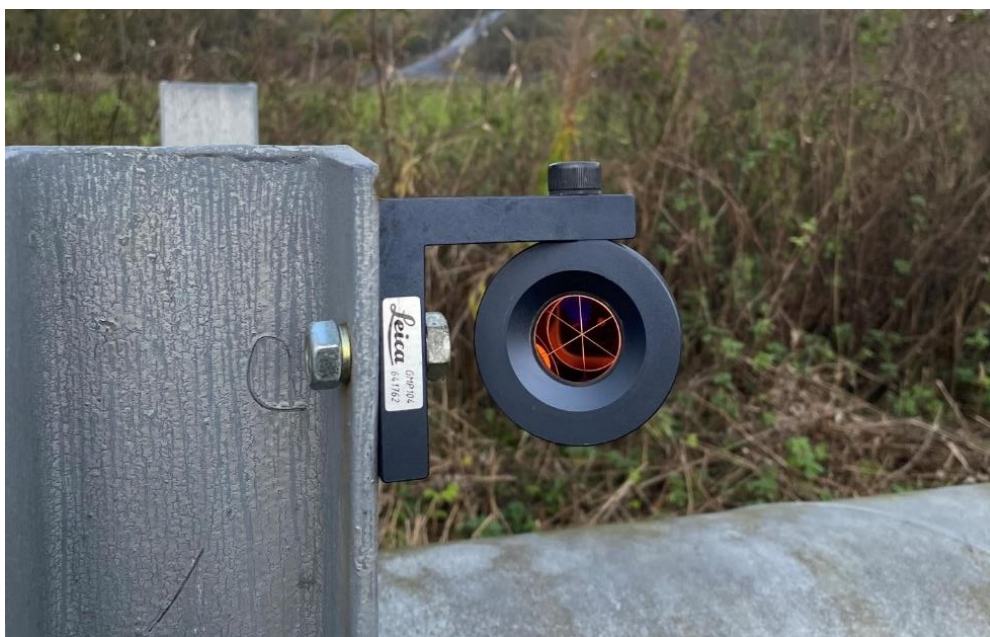
Obr. 8 Odrazný hranol na měření lokalitě Stonava – Mexiko (Koňáriková, 2023)
