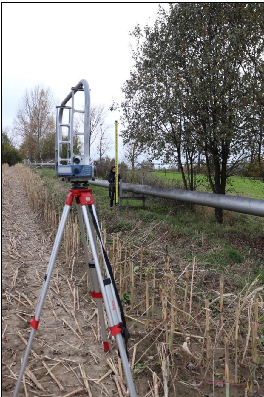
Příloha 1 Umístění nivelačního přístroje při zaměřování geodetických bodů (Hýlová, 2023)
