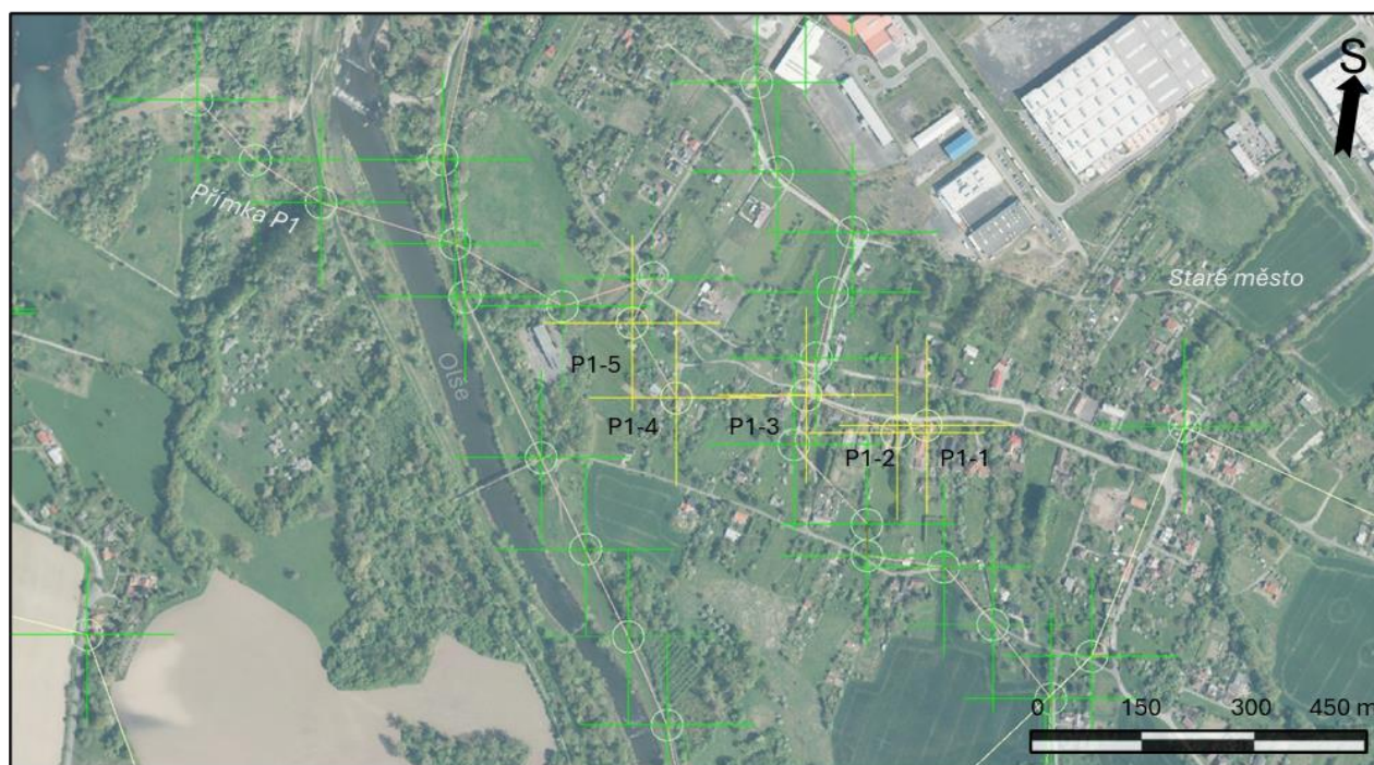
Obr. 14 Vyobrazení nivelačních bodů (zeleně – viz. příloha 2) s vyznačením bodů P1-1, P1-2, P1-3, P1-4, P1-5 (žlutě) s výrazným poklesem lokalita Staré město u Karviné na mapě
