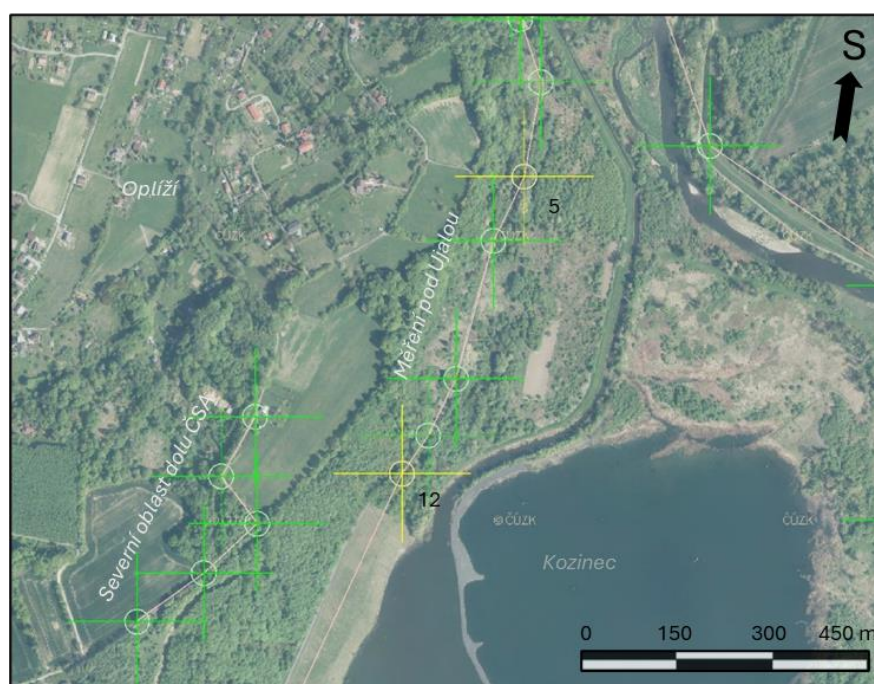
Obr. 12 Vyobrazení nivelačních bodů (zeleně – viz. příloha 2) s vyznačením bodů 5 a 12 (žlutě) s výrazným poklesem lokalita Doubrava na mapě
