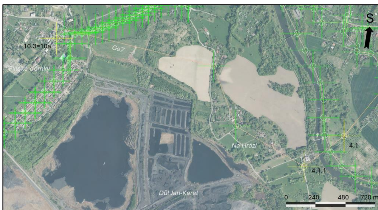
Obr. 15 Vyobrazení nivelačních bodů (zeleně – viz. příloha 2) s vyznačením bodů 4.1, 4.1.1, 10.3=10a (žlutě) s výrazným poklesem na nivelačním pořadu Ge7
