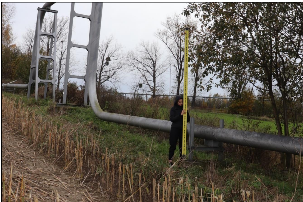
Příloha 4 Nivelační měření na lokalitě Stonava – Mexiko pomocí 3m nivelační latě (Hýlová, 2023)
