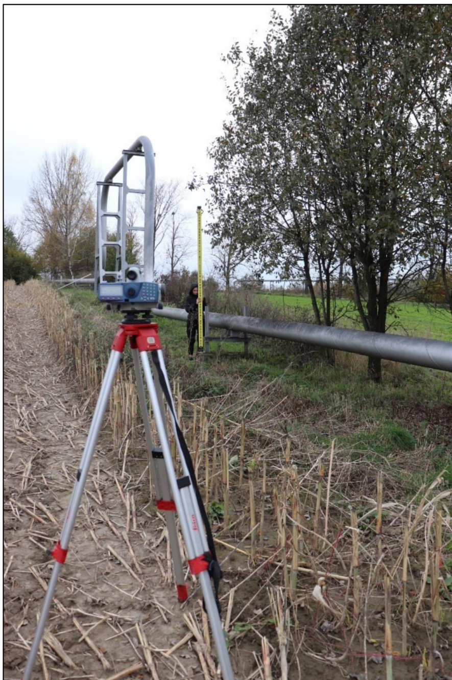
Příloha 1 Umístění nivelačního přístroje při zaměrování geodetických bodů (Hýlová, 2023)
