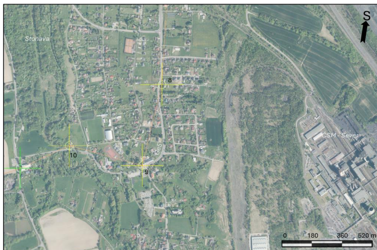
Obr. 15 Vyobrazení nivelačních bodů (zeleně – viz. příloha 2) s vyznačením bodů 8,9,10 (žlutě) s výrazným poklesem na nivelačním pořadu Ge5
