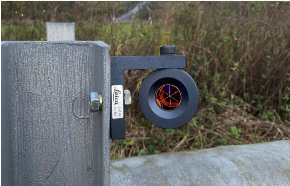
Obr. 8 Odrazný hranol na měření lokality Stonava – Mexiko (Koňáriková, 2023)
