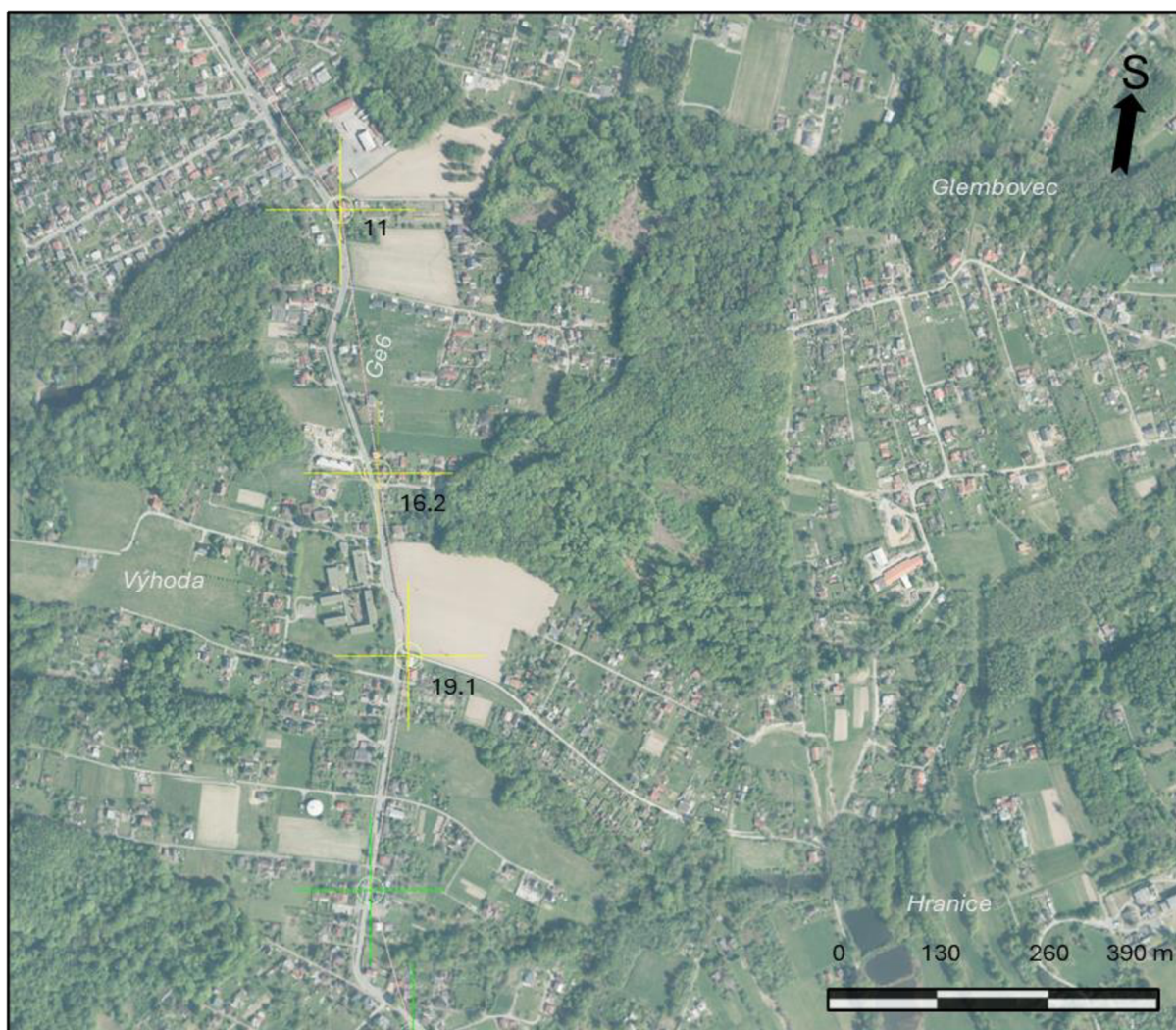
Obr. 16 Vyobrazení nivelačních bodů (zeleně – viz. příloha 2) s vyznačením bodů 11, 16.2, 19.1 (žlutě) s výrazným poklesem na nivelačním pořadu Ge6
