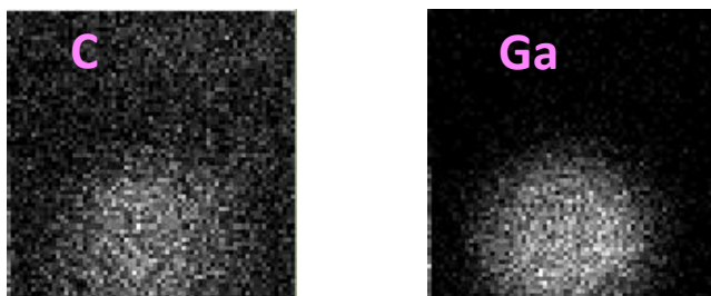
Obrázek 37: Povrchové rozložení prvků korespondující s růžovým spektrem na obrázku 36. Vlevo je rozložení signálu uhlíku, vpravo galia
