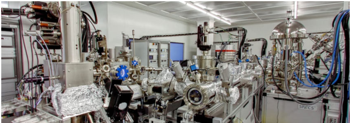
Obrázek 15: Fotografie komplexní aparatury pro depozici a analýzu nanostruktur SPECS sídlící v budově institutu CEITEC v Brně, jejíž součástí je také přístroj analýzy LEIS.
