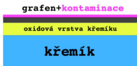
Obrázek 19: Popis vzorku grafenu. Destička je tvořena Si(100), na jehož povrchu je tenká vrstva nativního SiO 2 , na kterou je přenesen grafen.
