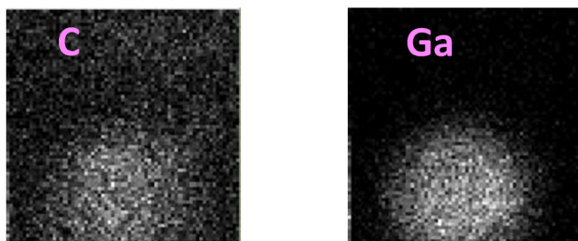
Obrázek 37: Povrchové rozložení prvků korespondující s růžovým spektrem na obrázku 36. Vlevo je rozložení signálu uhlíku, vpravo galia
