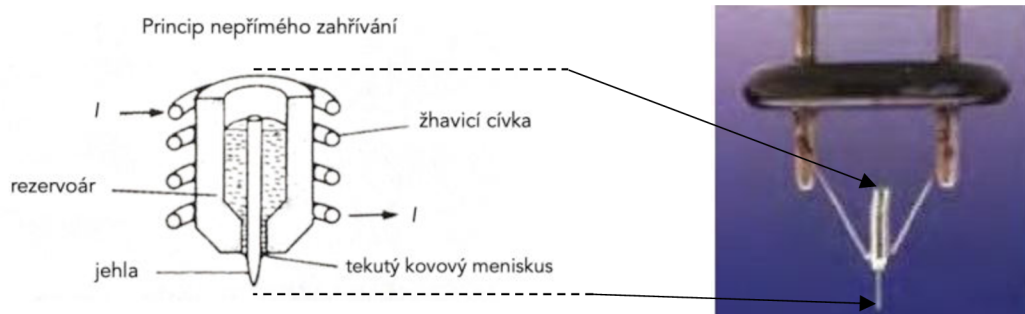
Obrázek 9: Schéma celého iontového zdroje s tekutými kovy (vlevo) a jeho reálná fotografie (vpravo). V rezervoáru nacházíme kov (nejčastěji galium), které zahřejeme nepřímo žhavicí cívkou. Tekutý kov steče po jehle ke hrotu, kde se vytvaruje do tenké trysky, ze které vytahujeme elektrickým polem ionty. Převzato z [25] a upraveno.
