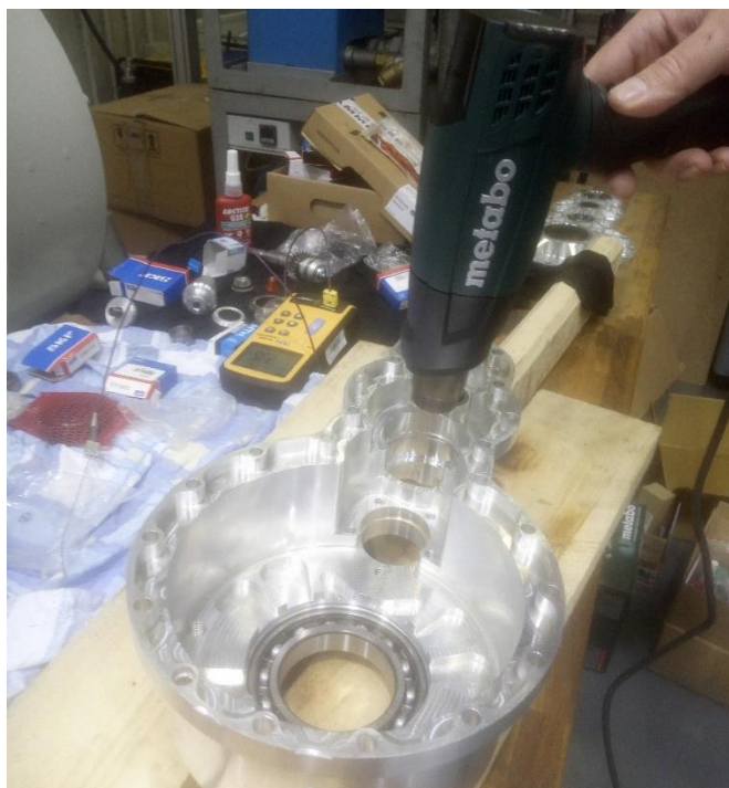
Obrázek 67: Ohřev Víka pro vkládání ložisek, na fotografii lze vidět i termočlánek pro kontrolu teplot
