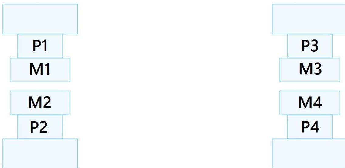
Obrázek 9: Blokové schéma koncepce uspořádání se čtyřmi motory a čtyřmi převodovkami ( M - motor, P – redukční převodovka, D - diferenciál)
