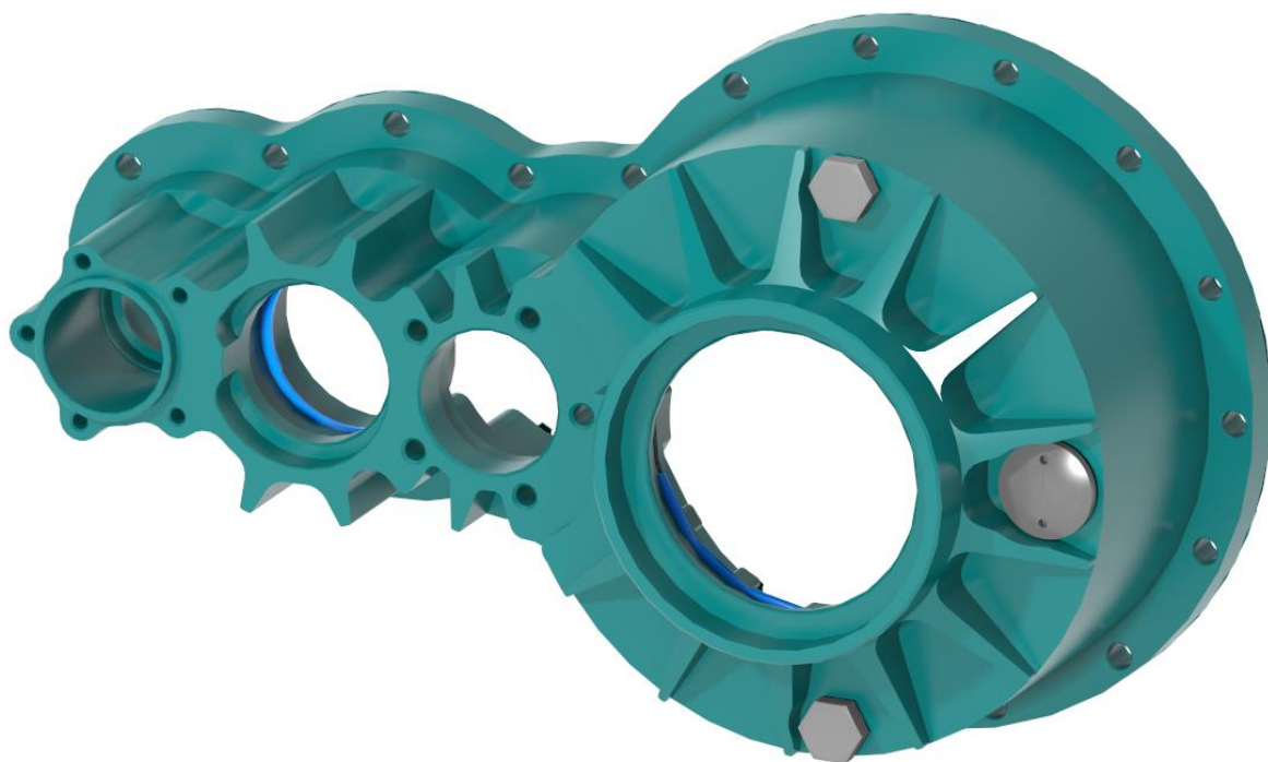
Obrázek 50: Víko. Pohled zepředu (lze vidět vypuštěcí šrouby, olejoznak či plochu na dosednutí příruby).
