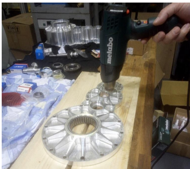
Obrázek 66: Ohřev Desky pro vkládání ložisek.
