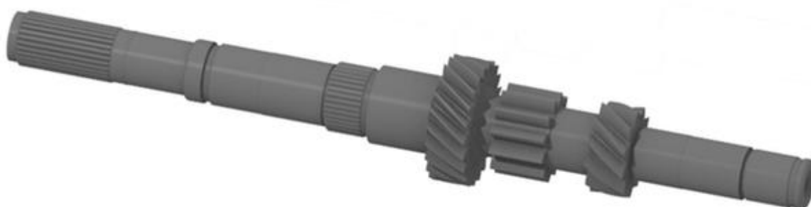
Obrázek 29: CAD model vstupního hřídele. Vytvořen pomocí reverzního inženýrství.
