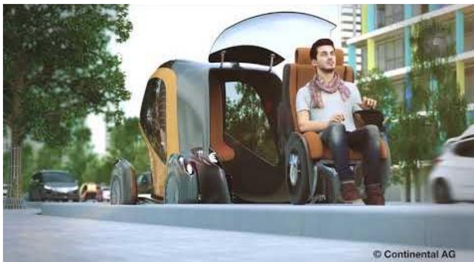
Obrázek 2: Continental Conti Bee v úpravě pro převoz vozičkáře [2]
