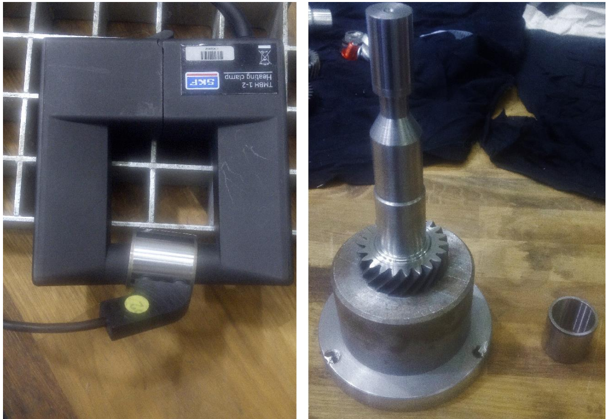
Obrázek 63: Vlevo - ohřev pouzdra pomocí indukčního ohřevu na přesnou teplotu, vpravo - ukázka ustavení hřídele pro osazení pouzdem.
