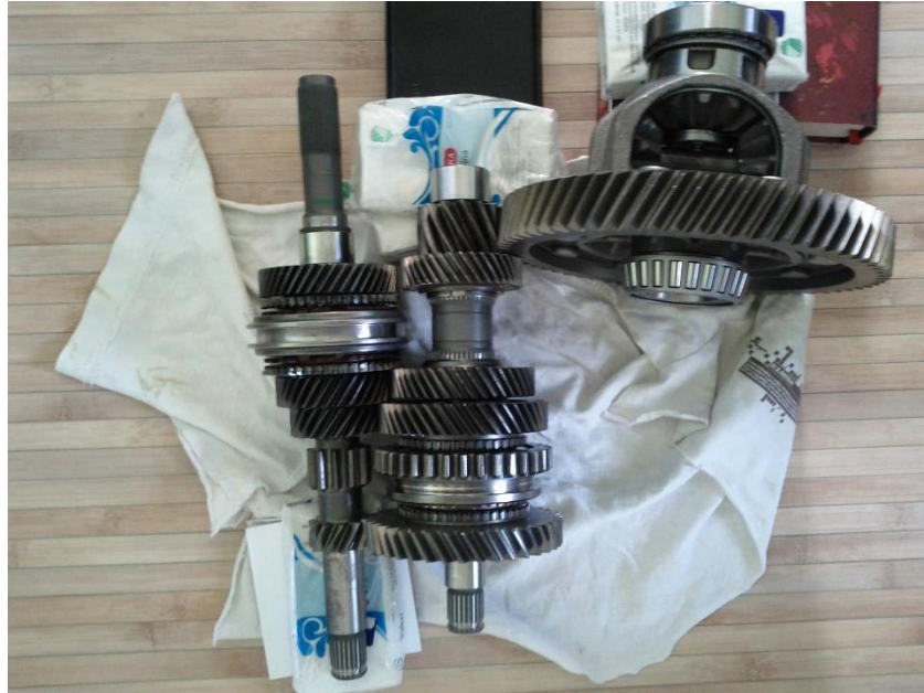
Obrázek 16: Převodovka MQ-200-5F, konkrétní kusy určené pro zástavbu do převodovky TUL
