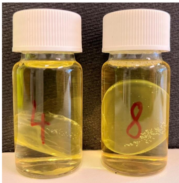
Obrázok 13: Fólie P(3HB) (vľavo) a P(3HB-co-4HB) (vpravo) s inkorporovaným kurkumínom 0,5 hm. % v 50% etanole po 24 hodinách
