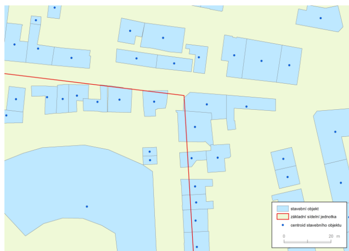
Obr. 3 Hranice ZSJ protínající polygony stavebních objektů
