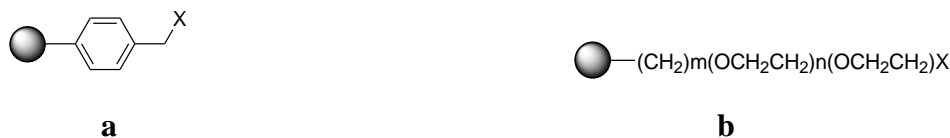
Obr. 3: Typy pryskyřic dle odlišné velikosti částic a schopnosti zvětšovat svůj povrch v daných rozpouštědlech: X – charakteristická funkční skupina linkeru; PS-DVB – chlor, hydroxy, amino (a); PEG-PS-DVB – brom, hydroxy, amino, thiol, karboxy (b) 36 .
