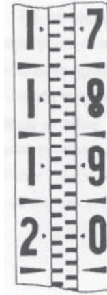
Obr.9 Invarové latě s centimetrovým dělením [5]
