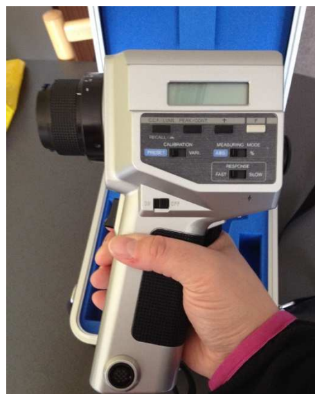
Obrázek 47: Měření denního osvětlení v interiéru vlevo na fotonku luxmetru, vpravo jasoměr [vlastní]
