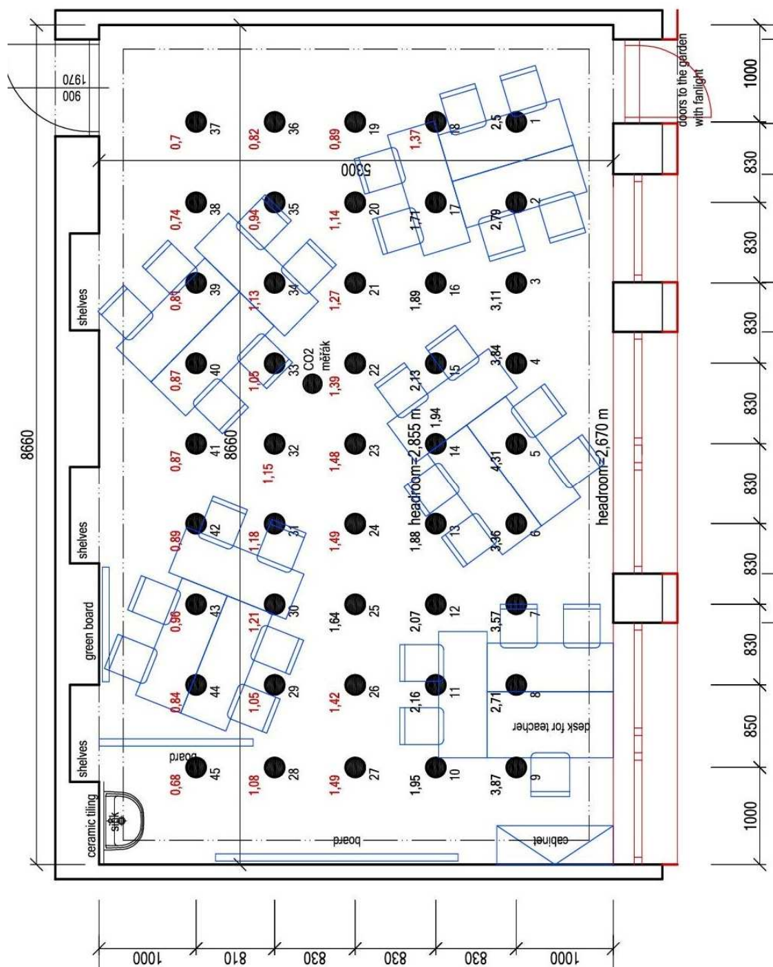
Obrázek 125: Půdorys učebny s umístěnými body a výsledky měření – nový stav, nevyhovující hodnoty zvýrazněny červeně (pod 1,5 % č.d.o.) [vlastní]
