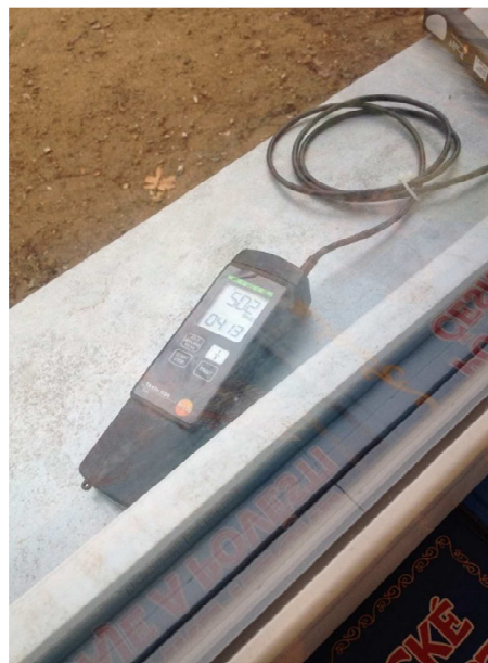
Obrázek 46: Měření CO 2 s napojením na sondu – interiér, exteriér [vlastní]
