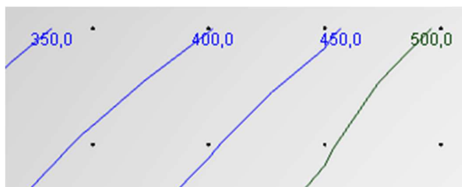
Obrázek 11: Ukázka výsledku z programu – jedná se o izočáry spojující místa se stejnou osvětleností v lux (na pracovní rovině) [33]
