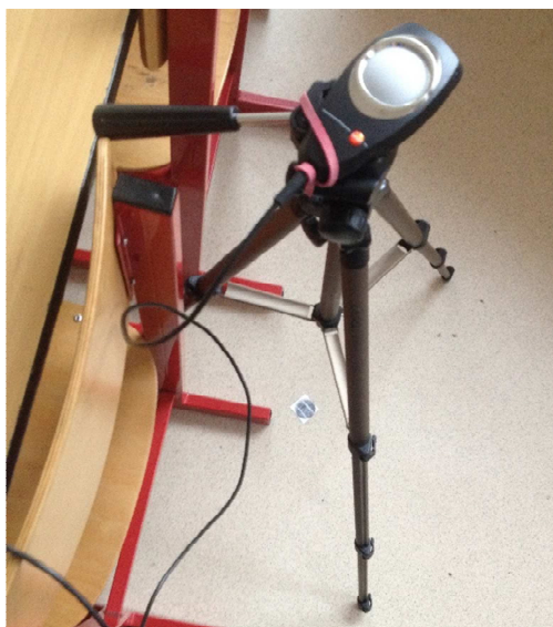
Obrázek 47: Měření denního osvětlení v interiéru vlevo na fotonku luxmetru, vpravo jasoměr [vlastní]
