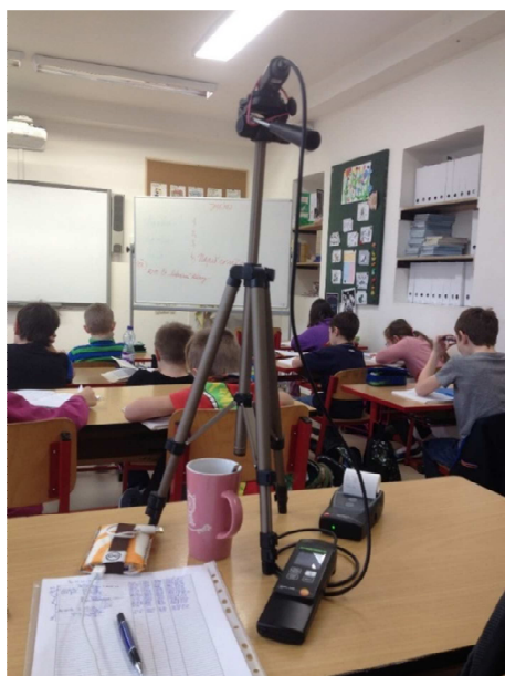
Obrázek 46: Měření CO 2 s napojením na sondu – interiér, exteriér [vlastní]
