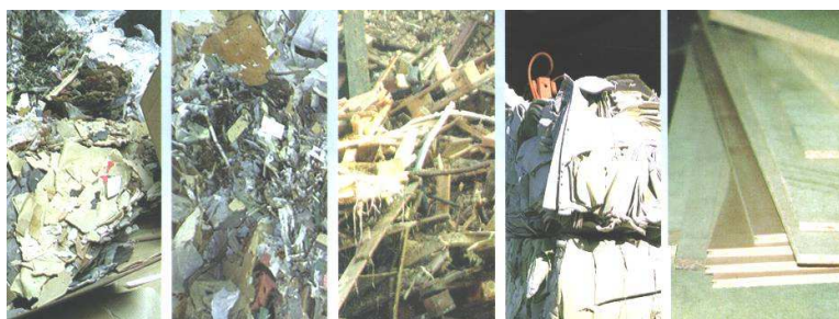
Obr. 4: Příklady vstupních surovin pro výrobu tuhého alternativního paliva
