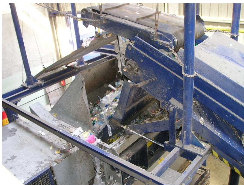
Obr. 18: Vstup materiálu do drtiče MICROMAT MS 2000
