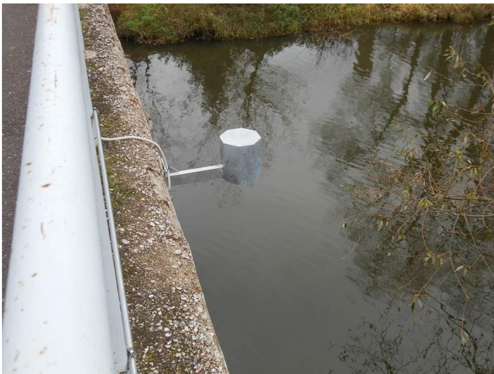
Obr. č. 19: Čidlo varovného systému připevněné na silničním mostě v Sedlčanech
