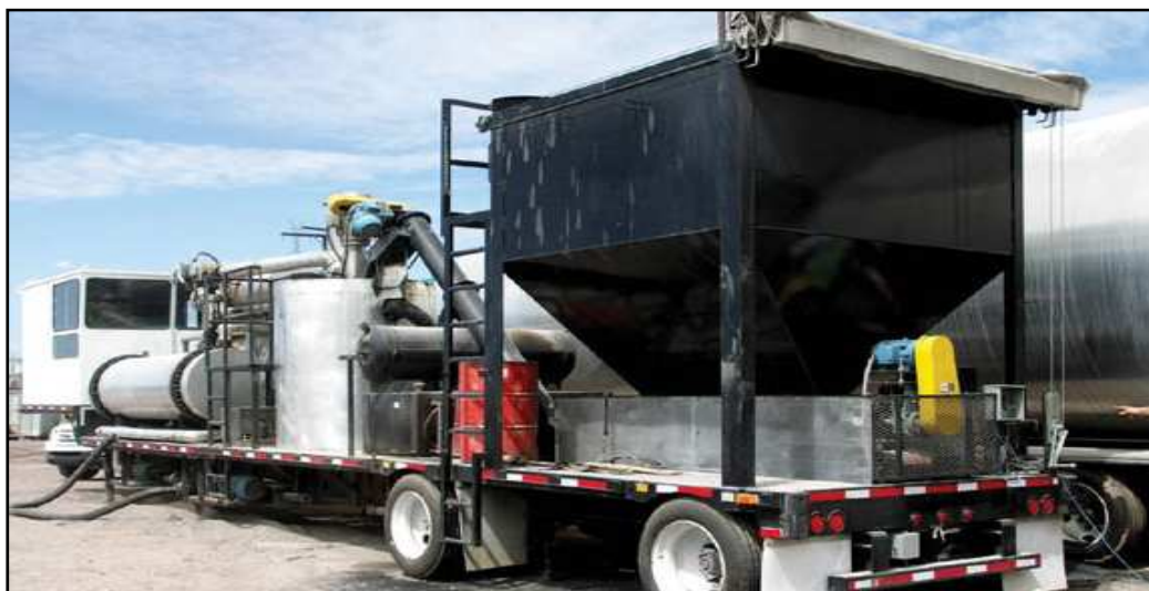
Obrázek 4: Míchací souprava ECOPATH pro přípravu gumoasfaltového pojiva
