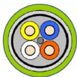
Obrázek 27: Průřez profinet kabelu, Zdroj: [7]
