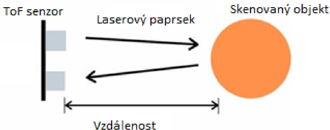
Obrázek 13 (upraveno) - Princip funkce odrazu světla od skenovaného objektu [43]
