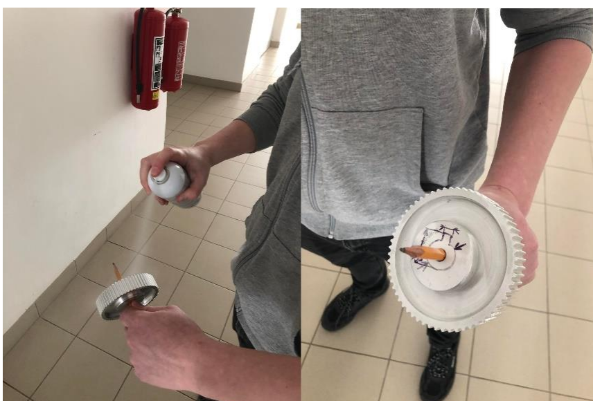
Obrázek 32 – (vlevo) Aplikace křídý ve spreji, (vpravo) konečný výsledek
