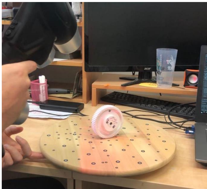
Obrázek 34 - Deformace laserového obrazce
