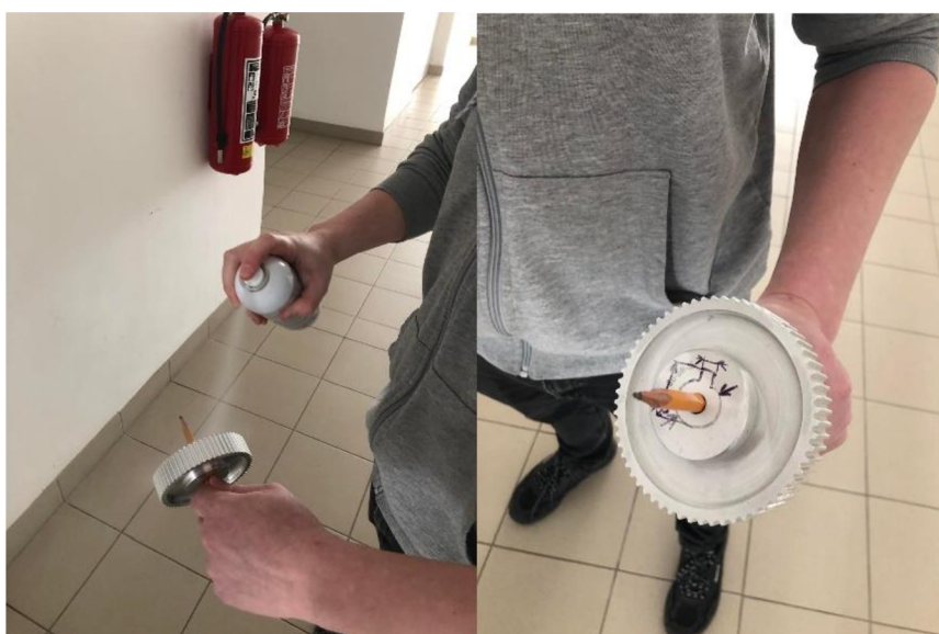
Obrázek 32 – (vlevo) Aplikace křídou ve spreji, (vpravo) konečný výsledek
