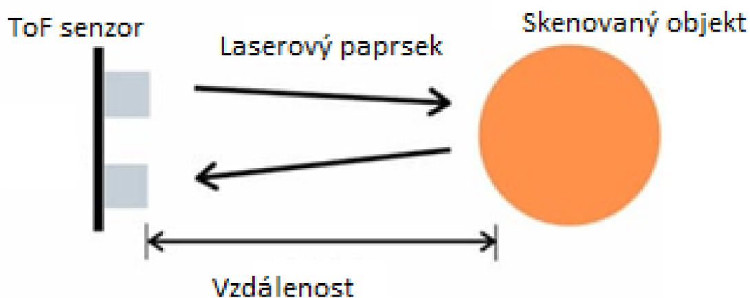
Obrázek 13 (upraveno) - Princip funkce odrazu světla od skenovaného objektu [43]
