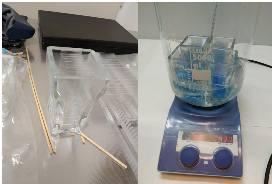
Obr. 3.15. – Vlevo: Skleněné nádoby na barvení objektů na podložních sklíčkách; Vpravo: Magnetická míchačka (RCT basic IKAMAG safety control) se skleněnými nádobkami na barvení uloženými ve vodní lázni (40 °C) pro snazší udržení teploty (Foto: Autor).
