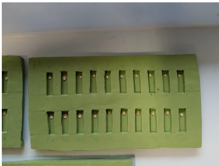
Obr. 3.9. Uložení misky lastury do komůrek gumové formičky (28 x 15 cm) pro zalití pryskyřicí (Foto: Autor).
