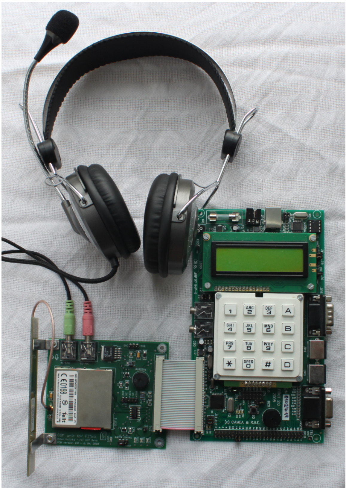
Obrázek C.2: FITkit s připojeným GSM modulem a sluchátky.
