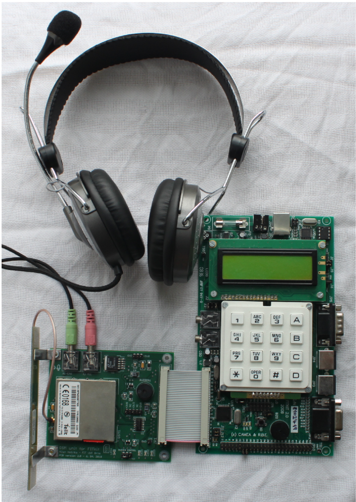
Obrázek C.2: FITkit s připojeným GSM modulem a sluchátky.
