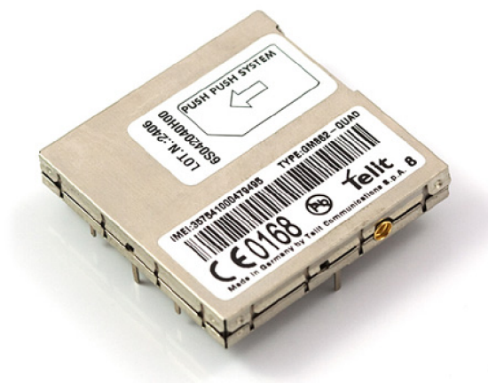
Obrázek 3.2: GSM modul Telit GM862-QUAD. Převzato z [2].
