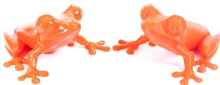
Obr. 4 Ukázka výtisku z ABS vyhlazený acetonem [32]
