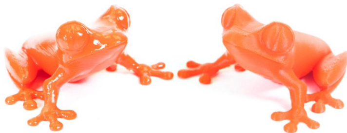
Obr. 4 Ukázka výtisku z ABS vyhlazený acetonem [32]
