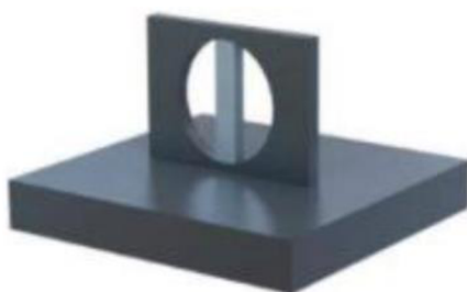
Obr. 7 Ukázka otvoru s podporou [35]
