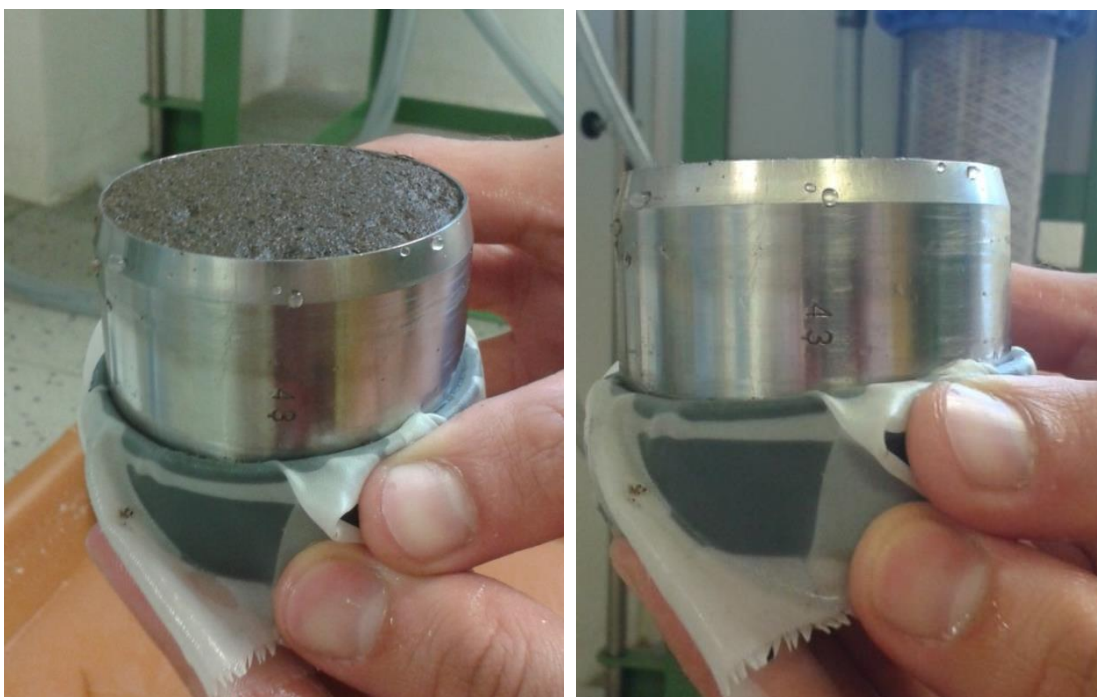
Obr. 4.4.2 – 1: Vzorek půdy po měření K_s . Nebyly pozorovány žádné objemové změny (autorka).
