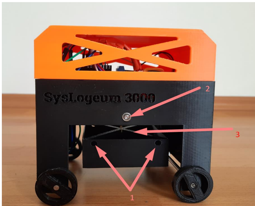
Obrázek 5: Starý model (1 - otvory pro první variantu, 2 - kříž pro druhou variantu, 3 - osa ve středu robota, skrz kterou jde vlákno). Převzato z (6).
