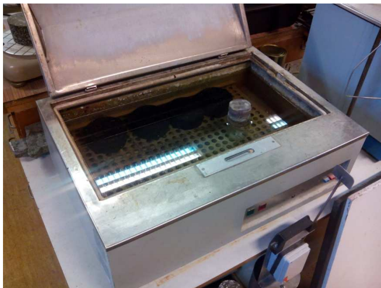
Obrázek 9.6 – Vodní lázeň na temperování mokrých těles na teplotu 40 °C
