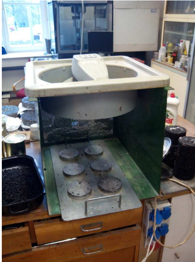
Obrázek 7.8 – Ventilátor pro urychlení vychladnutí směsi
