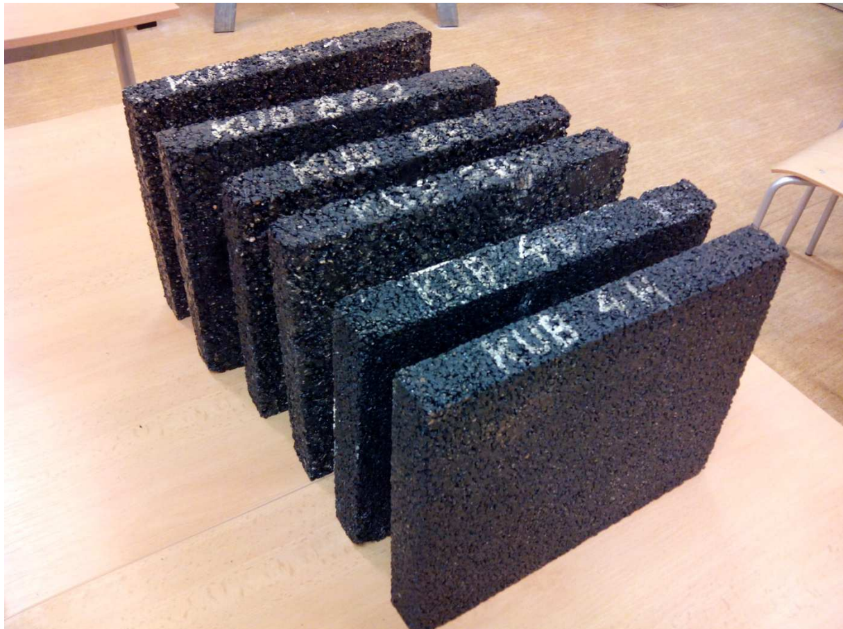
Obrázek 11.2 – Desky použité pro zkoušku odolnosti vůči trvalým deformacím
