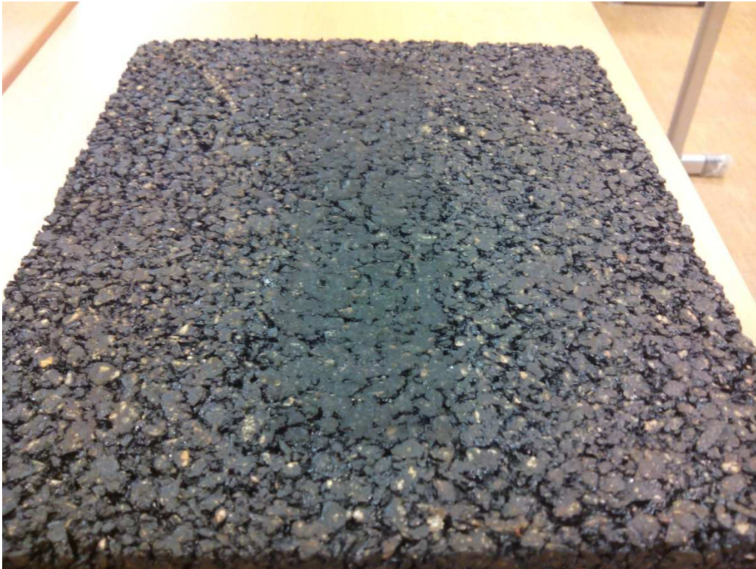
Obrázek 9.13 Vyjetá kolej na desce po zkoušce odolnosti vůči trvalým deformacím
