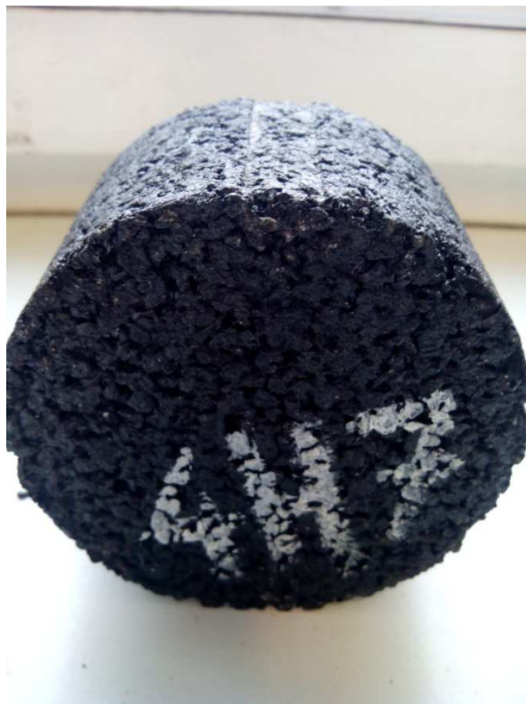
Obrázek 9.10 – Zkušební těleso po zkoušce pevnosti v příčném tahu ITS
