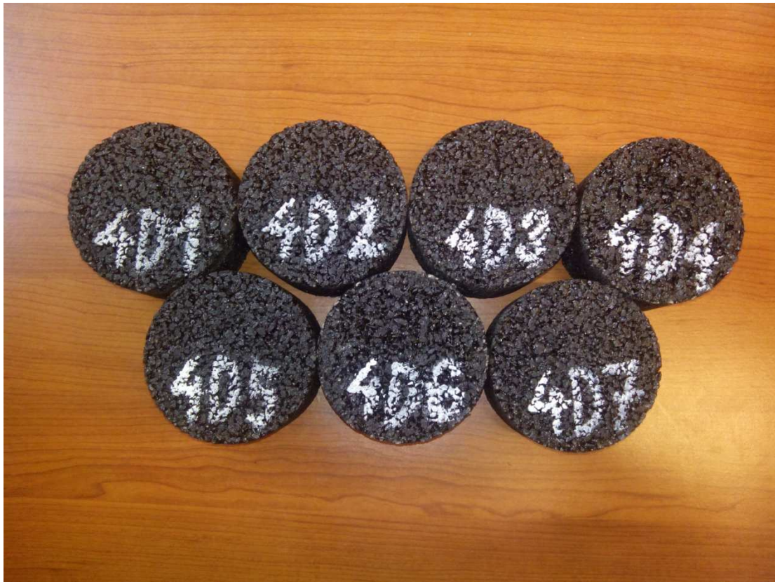
Obrázek 10.4 - Marshallova tělesa směsi BBTM 4 50/70 na dolní mezi zrnitosti pro zkoušku ITSR
