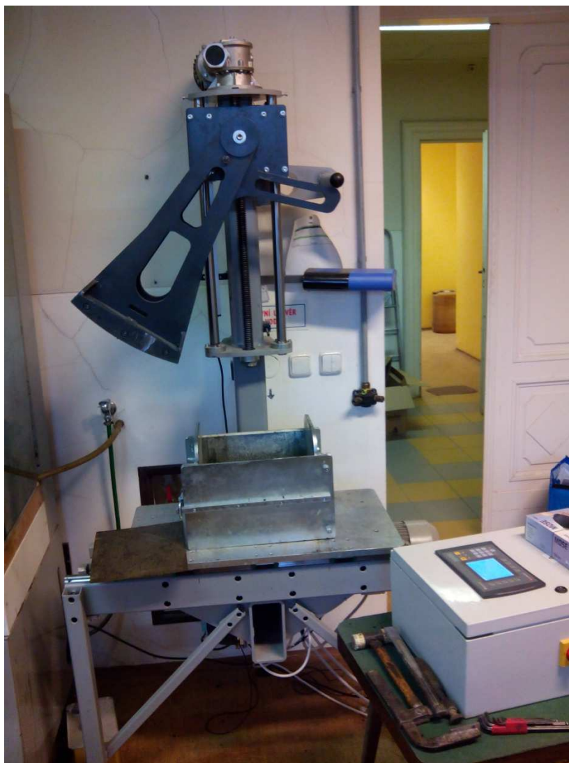
Obrázek 8.8 – Zhutňovač desek s řídicím panelem
