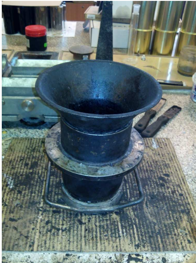
Obrázek 7.6 – Sestavená forma připravená na plnění asfaltovou směsí
