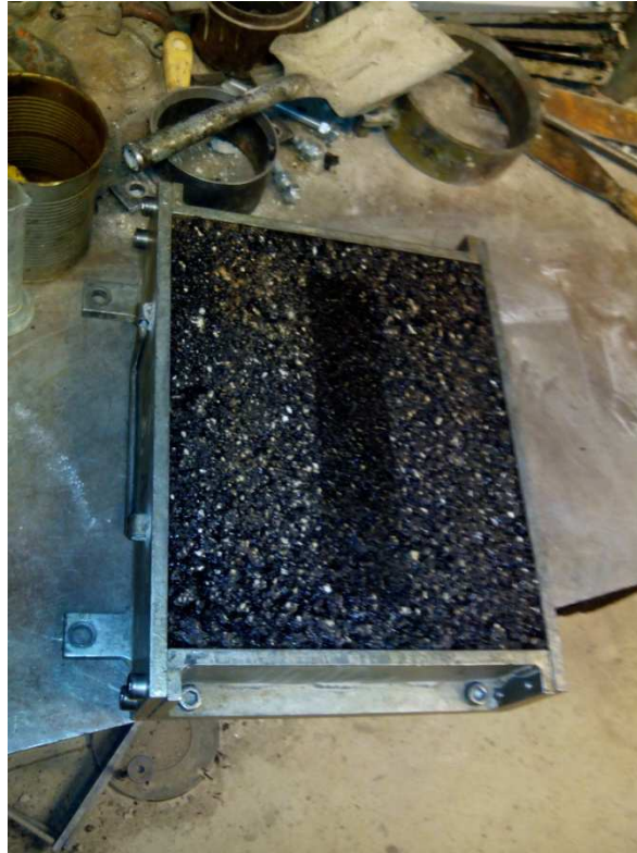
Obrázek 9.12 Deska upnutá do formy po zkoušce vyjždění kolem
