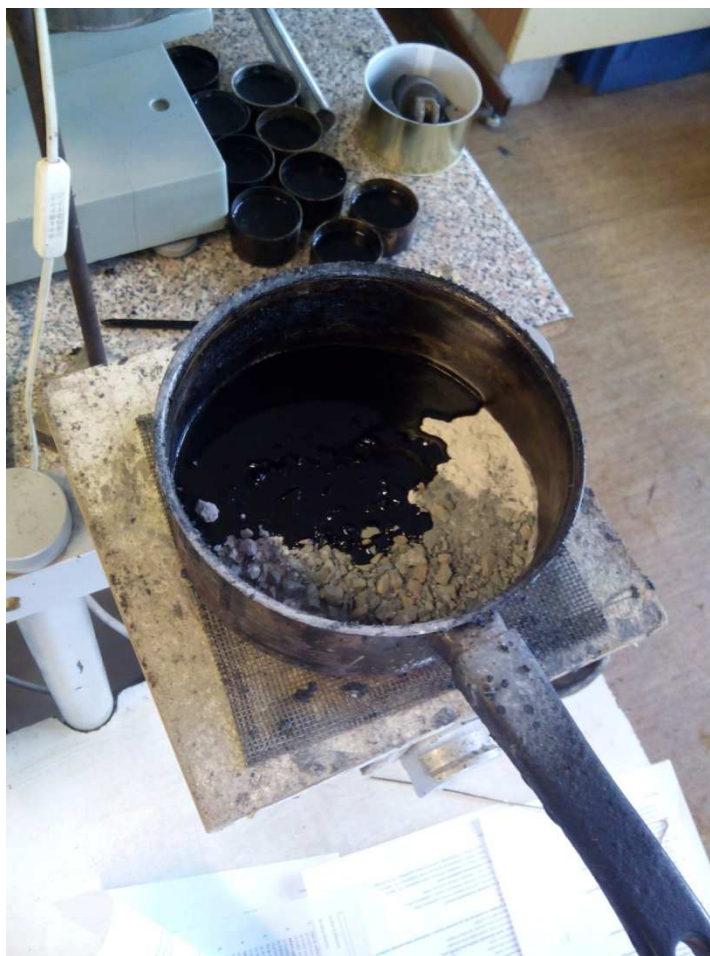
Obrázek 7.3 – Míchací nádoba s pojivem a kamenivem na váze
