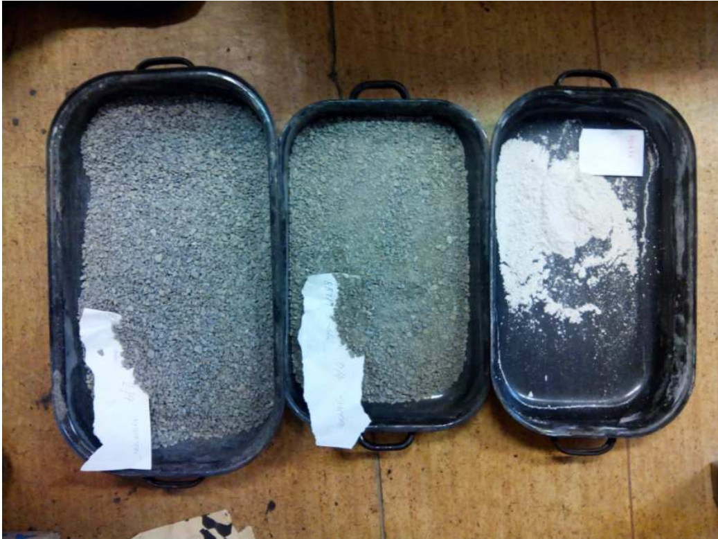
Obrázek 5.2 – Použitá kameniva (zleva: Luleč 2/4, Luleč 0/4, vápencová moučka Mokrá)
