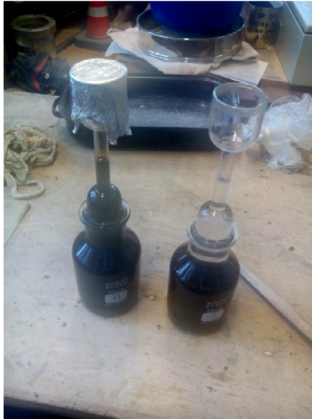
Obrázek 9.5 – Naplněné pykometry před zvážením (vlevo s trichlorethylenem, vpravo s vodou)
