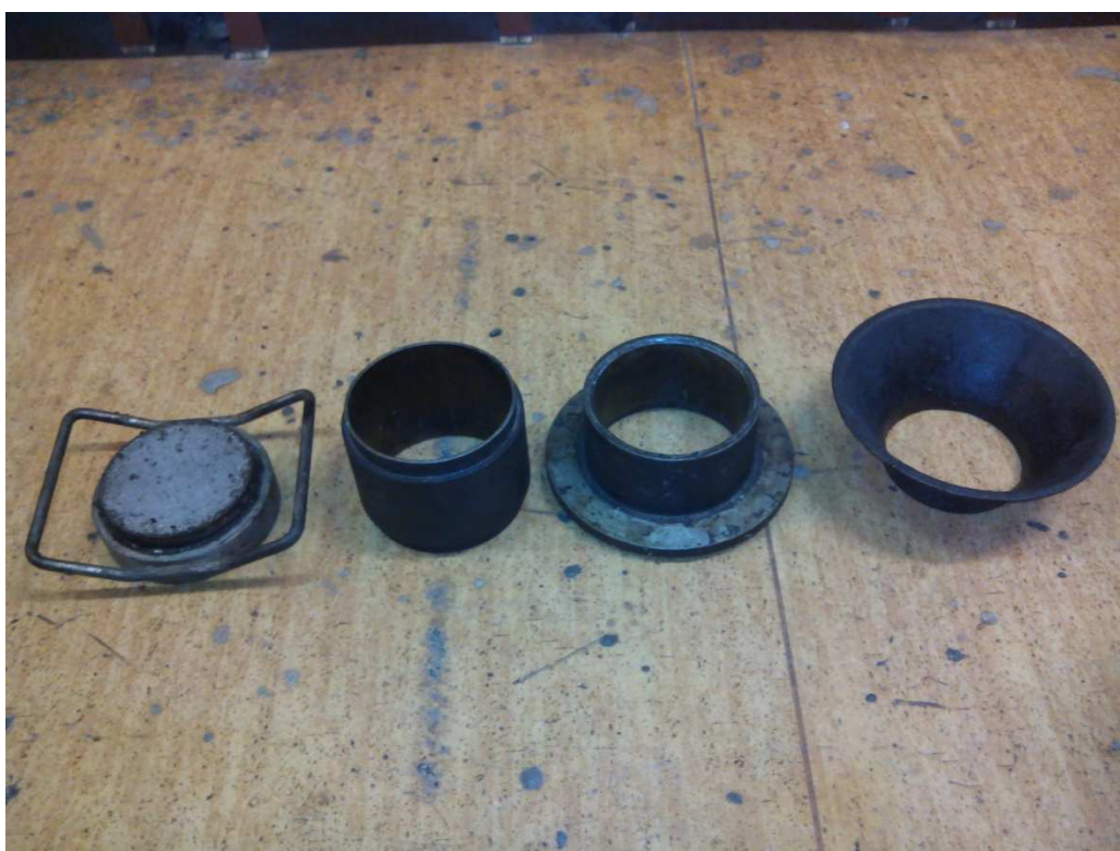
Obrázek 7.5 – Podložka, forma, nástavec a trychtýř pro výrobu Marshallových těles
