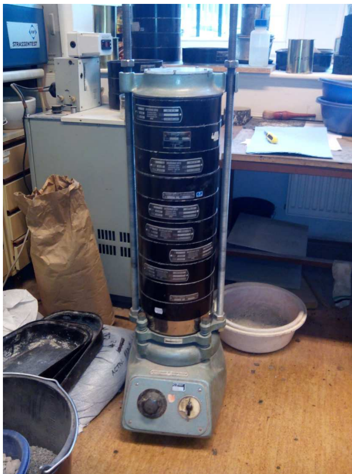
Obrázek 6.1 – Vibrační stroj pro síťový rozbor
