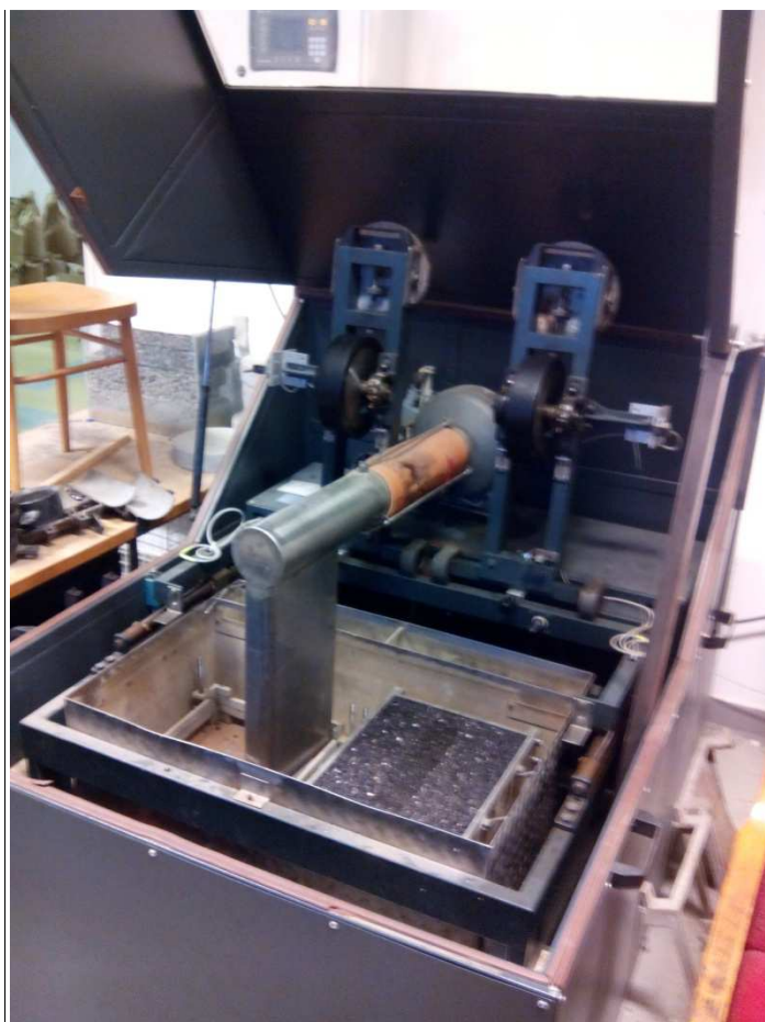
Obrázek 9.11 – Přístroj pro zatěžovací zkoušku poježdění kolem
