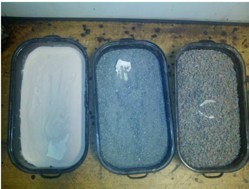
Obrázek 5.1 – Použitá kameniva (zleva: vápencová moučka, Sloupno 0/4, Žumberk 4/8)
