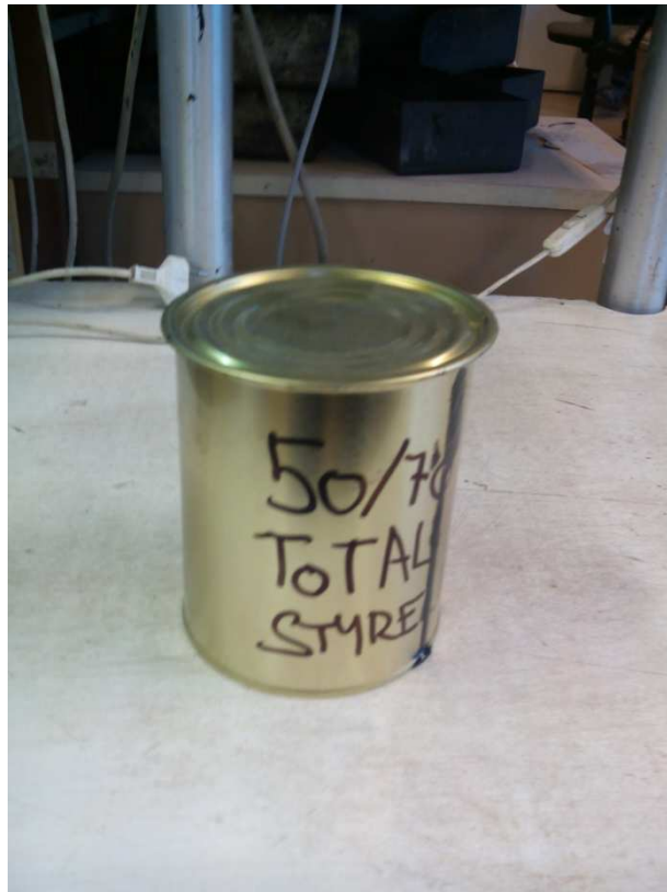
Obrázek 5.3 – Asfaltové pojivo TOTAL 50/70
