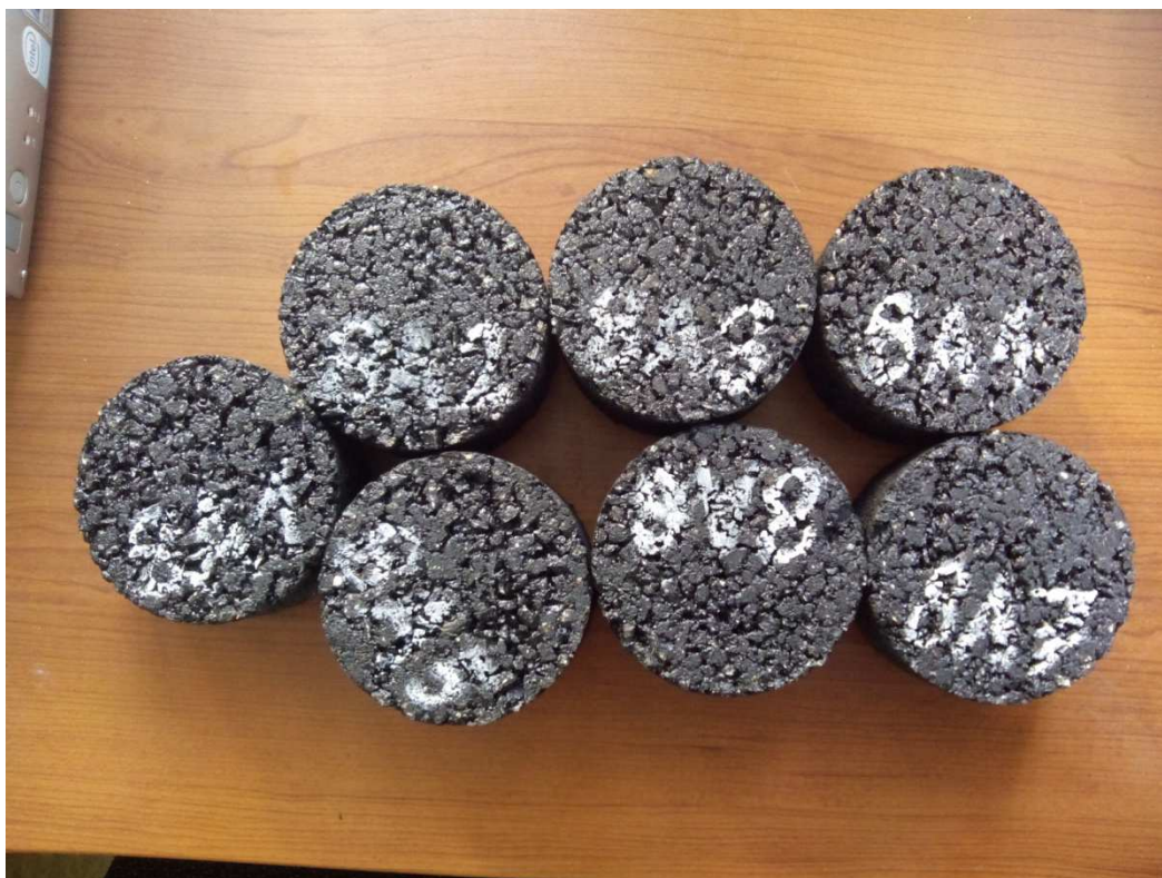
Obrázek 10.1 – Marshallova tělesa směsi BBTM 8A 45/80-65 pro zkoušku ITSr
