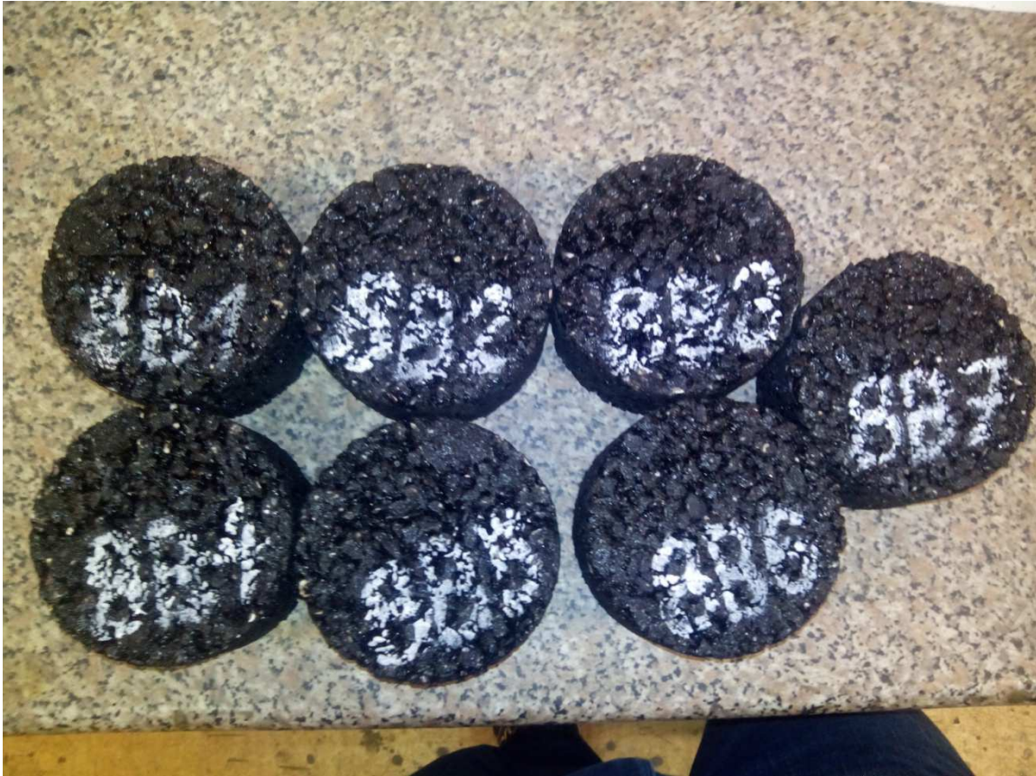
Obrázek 10.2 - Marshallova tělesa směsi BBTM 8B 45/80-65 pro zkoušku ITSR
