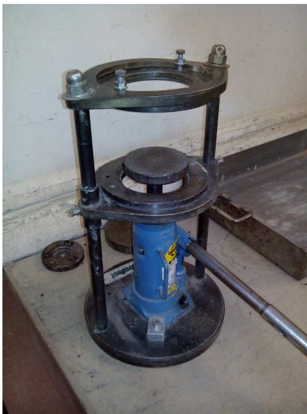
Obrázek 7.9 – Hydraulický lis pro vytlačování Marshallových těles z formy
