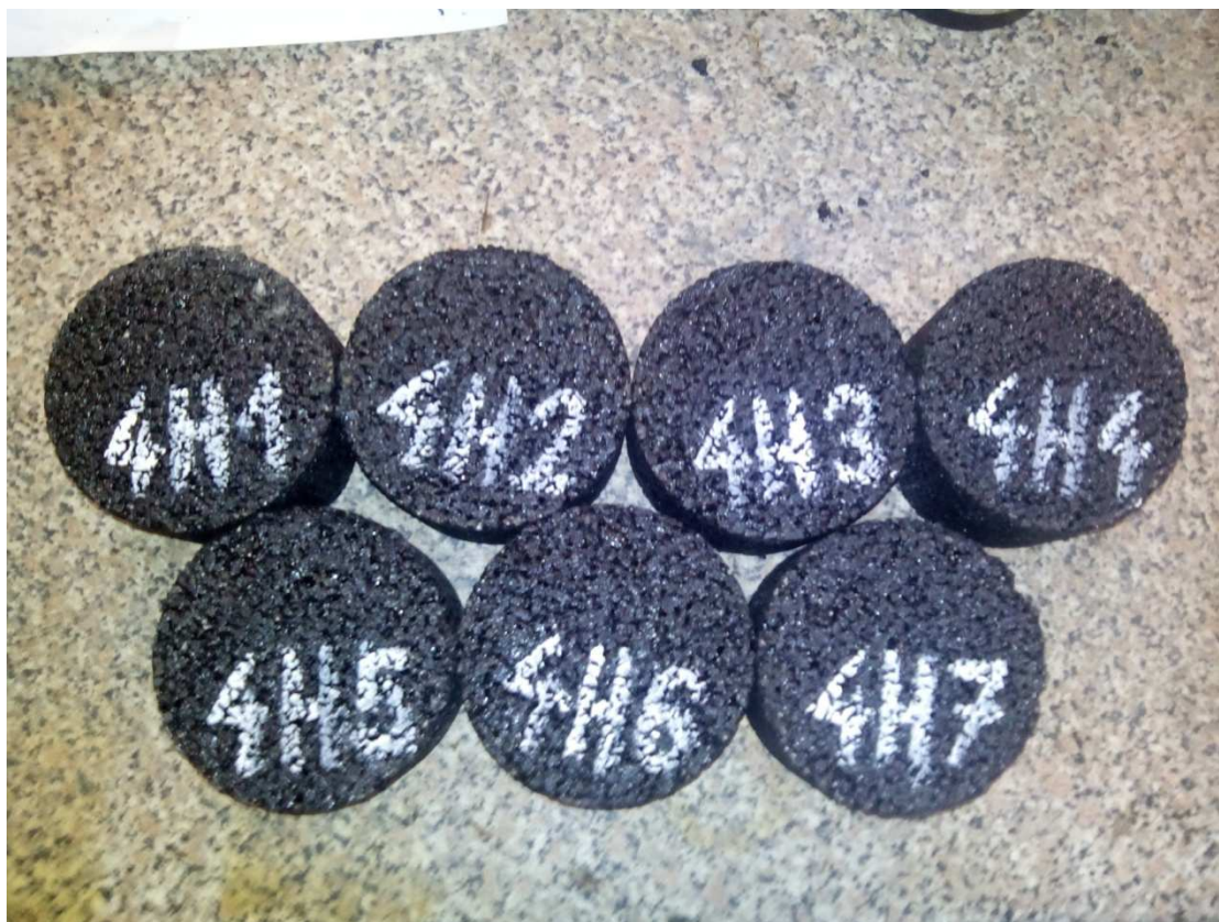
Obrázek 10.3 - Marshallova tělesa směsi BBTM 4 50/70 na horní mezi zrnitosti pro zkoušku ITSR
