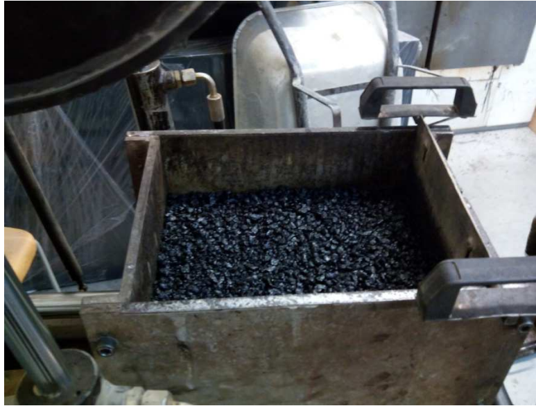
Obrázek 8.4 – Urovnání směsi ve zhutňovači desek
