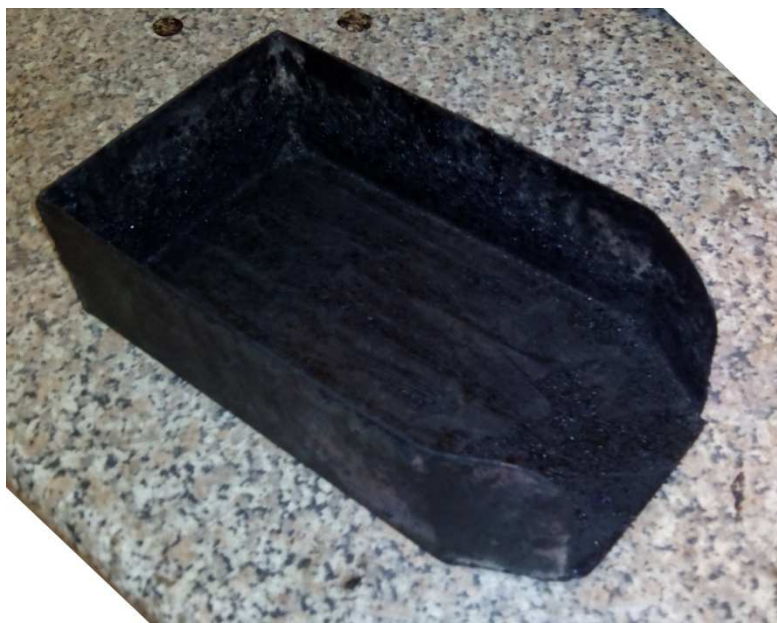
Obrázek 7.4 – Miska pro temperování na teplotu hutnění
