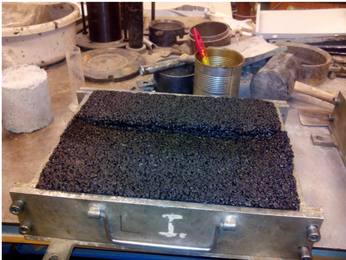
Obrázek 10.6 - Deska směsi BBTM 4 50/70 na dolní mezi zrnitosti ve formě po zkoušce vyjždění kolem
