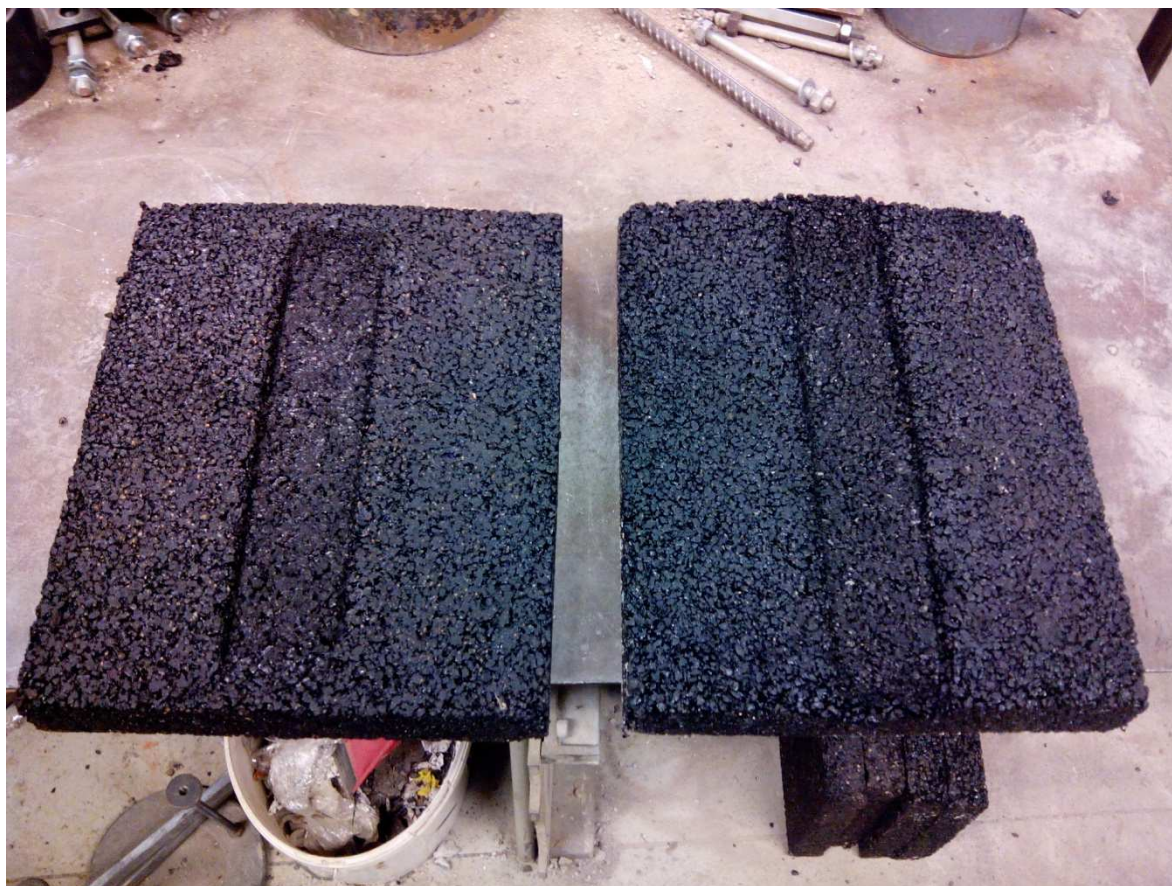
Obrázek 10.7 – Desky po zkoušce odolnosti vůči trvalým deformacím (vlevo – deska ze směsi BBTM 4 50/70 na horní mezi zrnitosti, vpravo – deska ze směsi BBTM 4 50/70 na dolní mezi zrnitosti)
