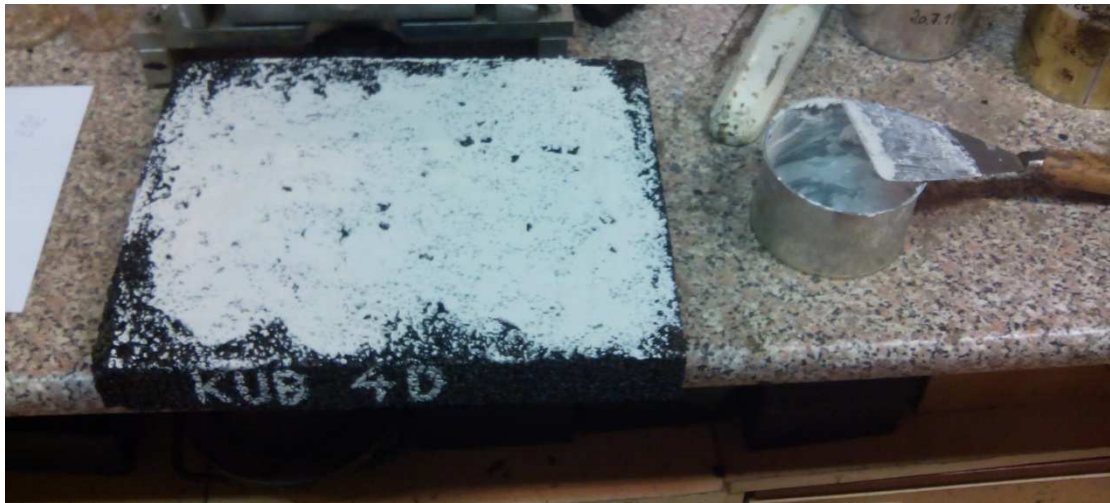
Obrázek 10.5 Opravení spodní části desky KUB 4D pro použití pro zkoušku odolnosti vůči trvalým deformacím
