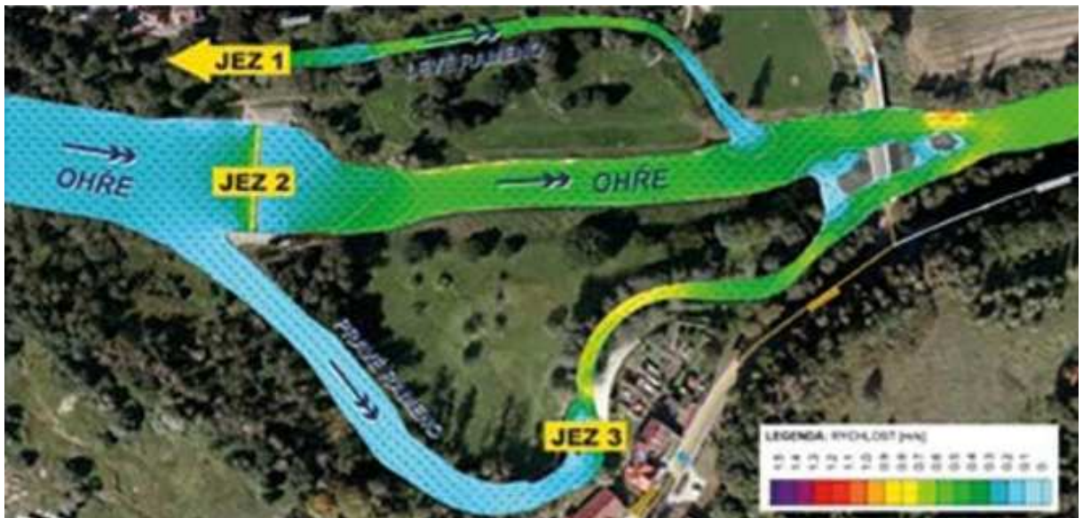
Obrázek č. 7: Kynšperk nad Ohří – rychlostní pole v jednotlivých ramenech za průtoku Q210d (Převzato z Bůžek et al, 2014).
