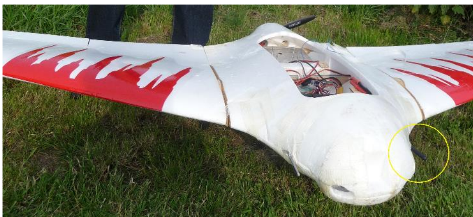
Obrázek 4.1: Umístění instalace antény v modelu Skywalker
