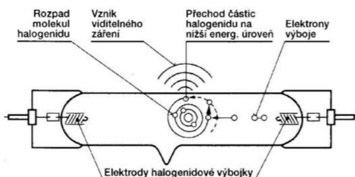
Obr. 14: Konstrukce halogenidové výbojky (URL 14)
