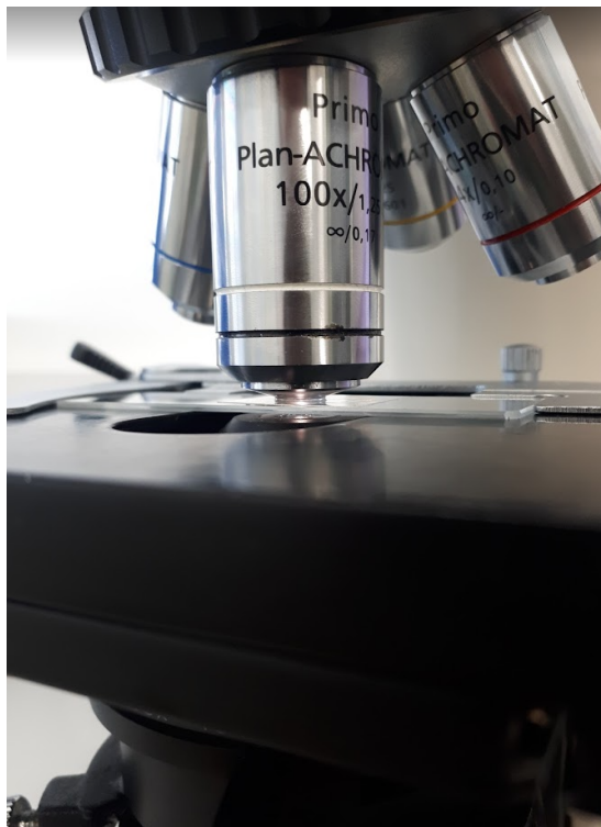
Obr. 2 Imerzní objektiv se 100x zvětšením (Petr Widenka 2022)
