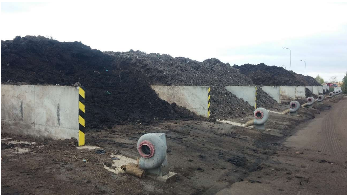
Obr. 15: Zakládka v jednotlivých kretech s provzdušňovacím zařízením [BYSTŘICKÝ, 2015]
