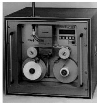
Kontinuální analyzátor na principu absorpce \beta -záření (Compendium of methods for Organic Compounds US EPA 1999)
