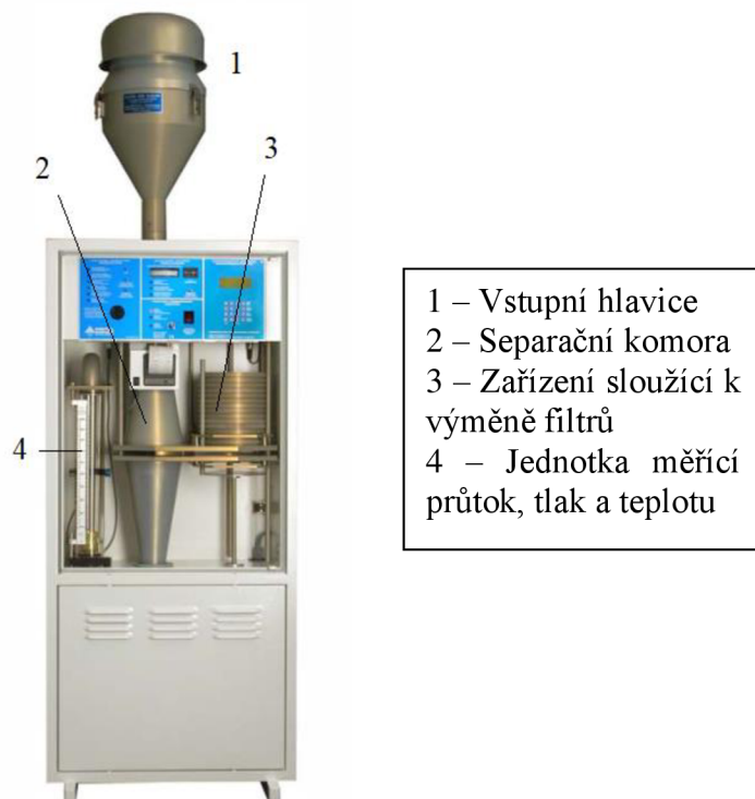
Obr. 2.1 Fotografie a stručný popis vzorkovacího zařízení DIGITEL DHA-80 [23].
