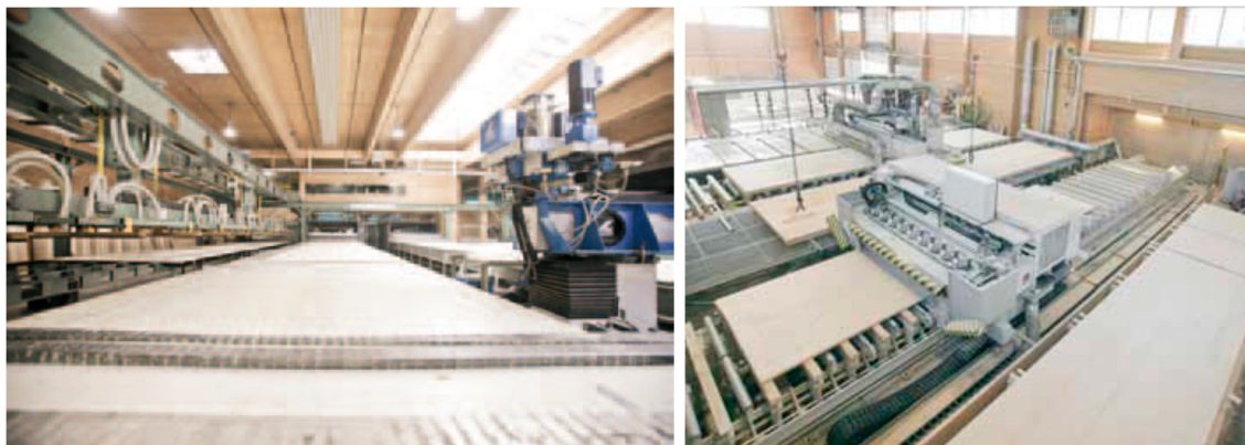
Obrázek 25 – Lepení a formátování CLT panelu z archivu KLH Massivholz GmbH (2021) | © KLH Massivholz GmbH
