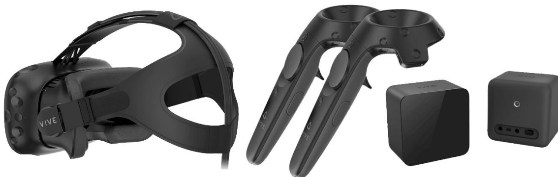
Obrázek 18 - HTC Vive – Headset, ovladače a sledovací základny
