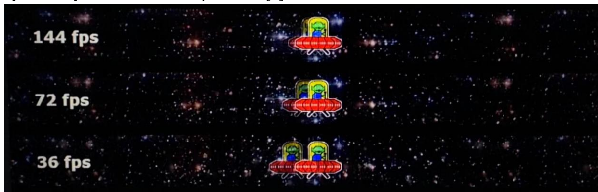
Obrázek 3 - UFO test – Zobrazení rozdílu mezi snímky při různých FPS [testufo.com]
