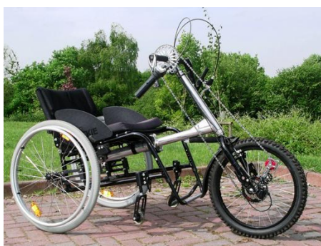
Obrázek 8. Příklad cykloadaptéru připevněný k ortopedickému vozíku (DisabledGear, 2015) a Elektro Handbike Comp (e-Totem, 2015).
