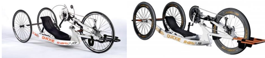
Obrázek 3. Silniční handbike Quickie Shark RT pro začínající jezdce a závodní silniční handbike Quickie Shark RS (Medicco, 2015).
