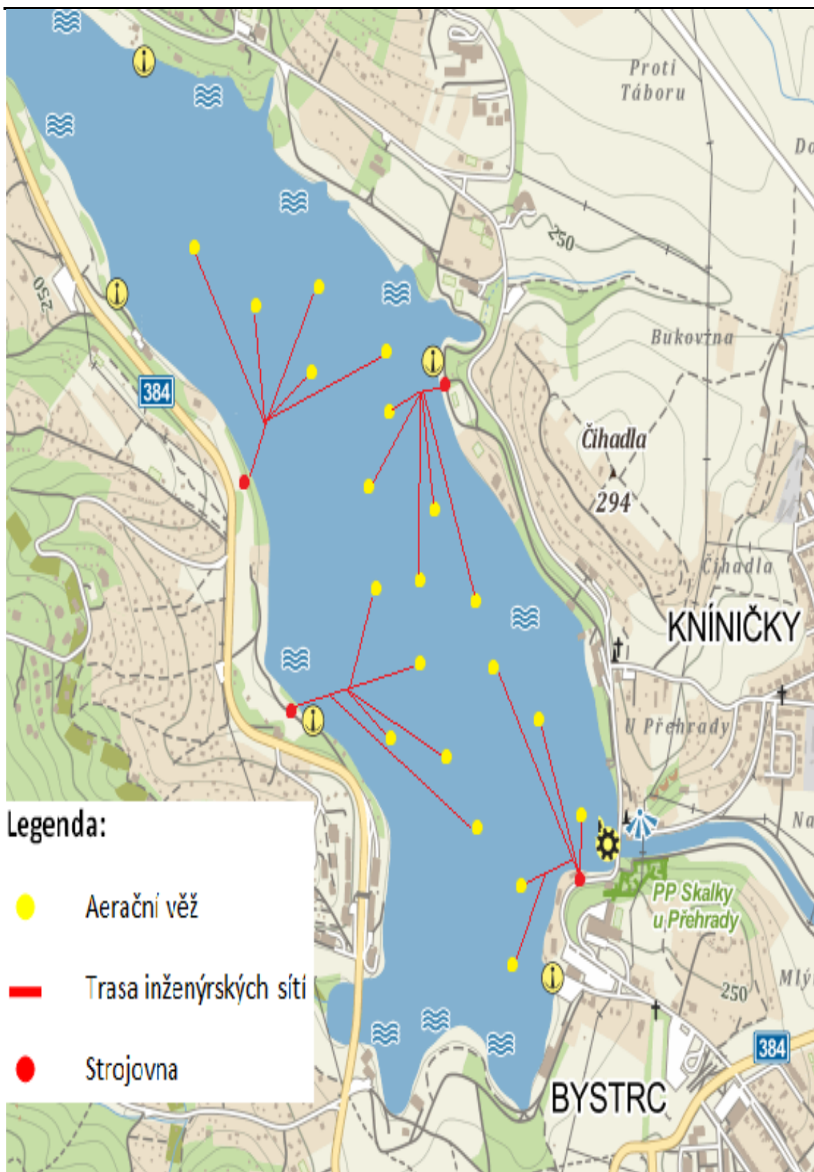
Obr. 5.2 Rozmístění aeračních věží v Brněnské přehradě
