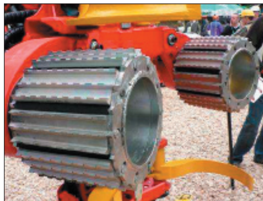
Obr. č. 8: Podávací válce s gumovým pásem a řetězy
